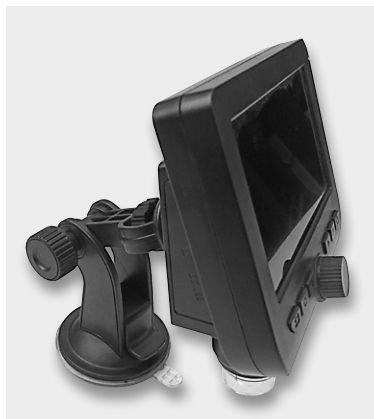
Bild 1: Ein einfacher Saugfußhalter hält das Gerät nicht lange, zudem bietet die leichte Konstruktion keine stabilen Ergebnisse.
