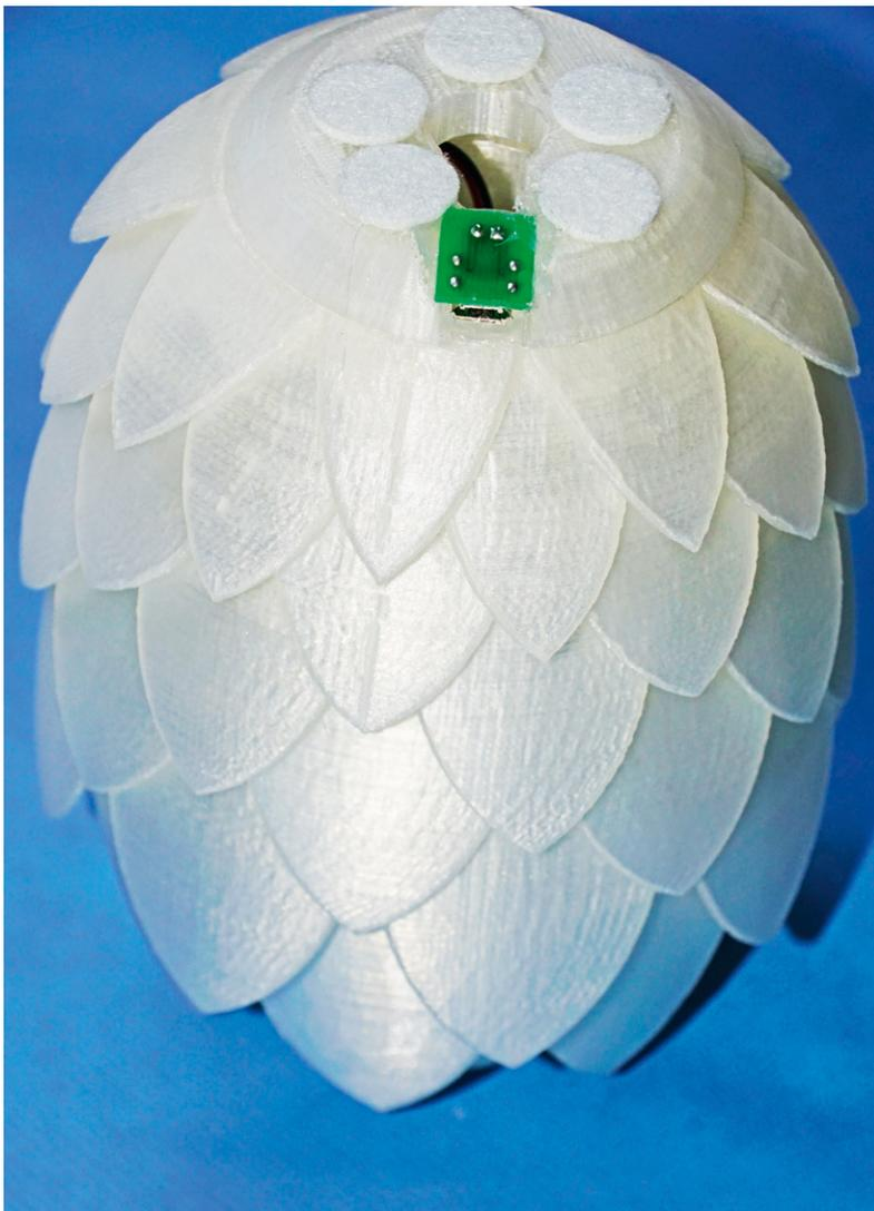
Bild 11: USB-Anschluss an der Unterseite
