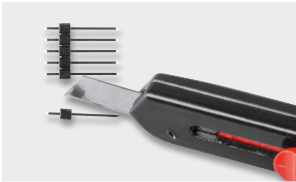
Bild 33: So wird die 5-polige Stiftleiste in fünf einzelne Stifte geteilt.
