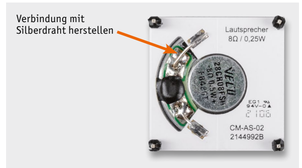
Bild 39: So wird die elektrische Verbindung zwischen dem Lautsprecher und den Platinenanschlüssen hergestellt.
