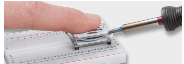
Bild 38: Unter leichtem Druck mit einem Finger werden die Lötstellen noch einmal erhitzt.
