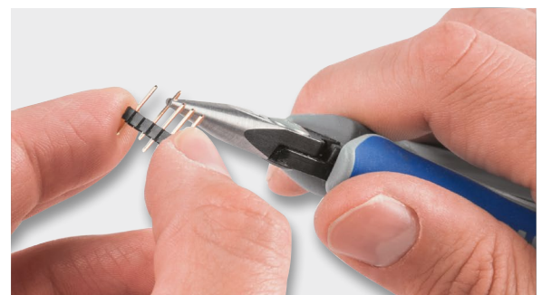
Bild 30: So werden nicht benutzte Stifte entfernt.
