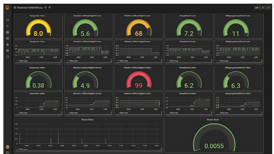
Bild 2: Ein mit Grafana erstelltes Dashboard zeigt die Daten der Datenbank in Echtzeit sowie in Langzeitdiagrammen an. Dieses Tool öffnet auch die weltweite Kontrollmöglichkeit per Internet.
