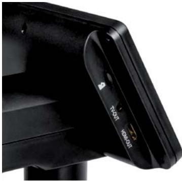
Bild 3: Anschlussvielfalt: Zusätzlich zur PC-USB-Verbindung bietet das Mikroskop FBAS- und HDMI-Ausgänge. Hier ist auch der microSD-Kartenslot zu sehen.
