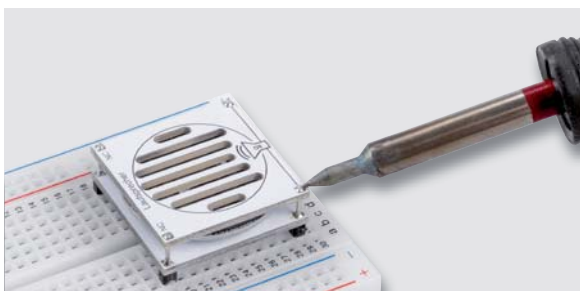
Bild 36: So werden die Stifte von oben mit der Platine verlötet.
