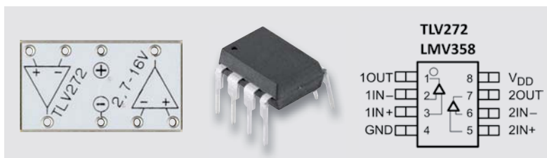
Bild 42: Der OP TLV272 als PAD (links) und im DIP-Gehäuse (rechts)
