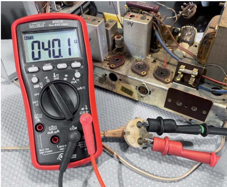
Bild 8: Messung des Widerstands des Netzprimärkreises
