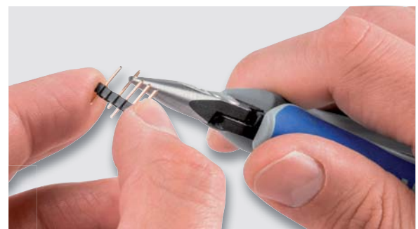
Bild 30: So werden nicht benutzte Stifte entfernt.
