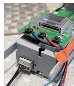
Bild 4: Für die lokale Ansteuerung des Fensterantriebs musste die WinMatic modifiziert werden – für Nick kein Problem.
