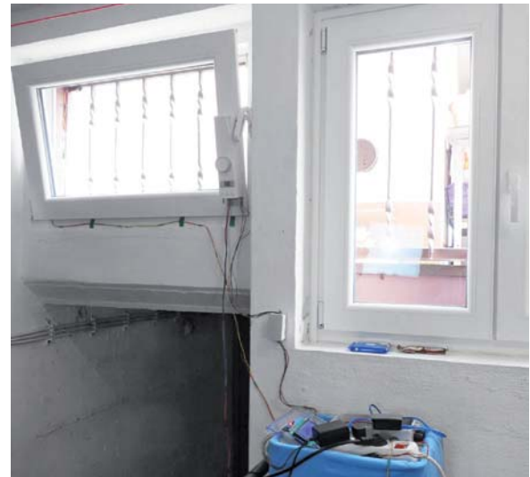
Bild 1: Das Projekt – hier sind u. a. der modifizierte Fensterantrieb WinMatic und einige Sensoren zu sehen – nimmt inzwischen auch in der praktischen Ausführung Gestalt an.
