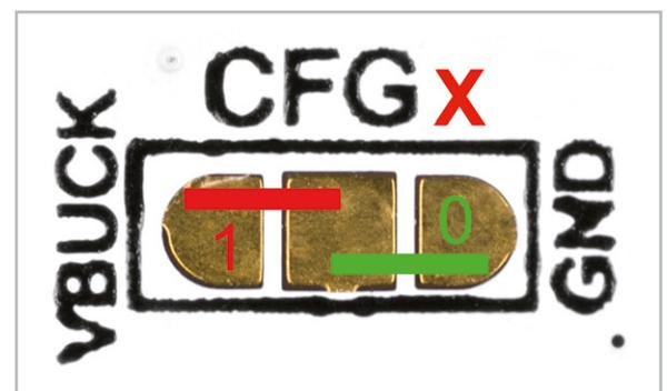
Bild 6: Konfiguration der Lötbrücken
