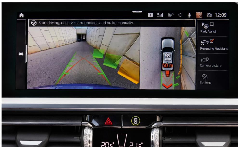
Bild 11: Der automatische Rückfahrassistent rangiert das Fahrzeug bis zu 50 m zurück aus engen Situationen. Bild: BMW
