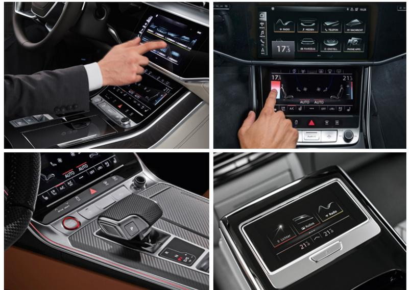
Bild 15: Auf dem Weg zum wirklich ergonomischen Touch-Display – das Audi-Display-Arrangement reagiert auf Gesten ebenso wie auf die virtuelle Tastenbetätigung mit taktile Rückmeldung. Dazu sind Displays in Funktionsgruppen unterteilt. Bilder: Audi
