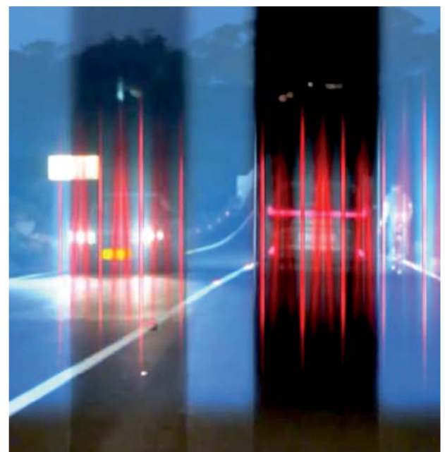
Bild 2: Die BladeScan-Technologie von Toyota erlaubt eine sehr ausdifferenzierte Erfassung des Verkehrs für die Fernlichtassistenz. Bild: Toyota
