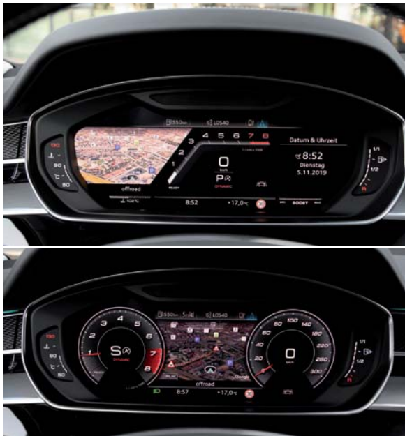
Bild 18: Im virtuellen Cockpit sind Zusatzinformationen und andere Instrumentenlayouts fast nach Belieben darstellbar. Bilder: Audi
