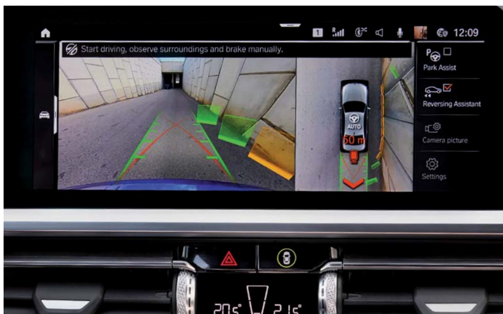
Bild 11: Der automatische Rückfahrassistent rangiert das Fahrzeug bis zu 50 m zurück aus engen Situationen. Bild: BMW
