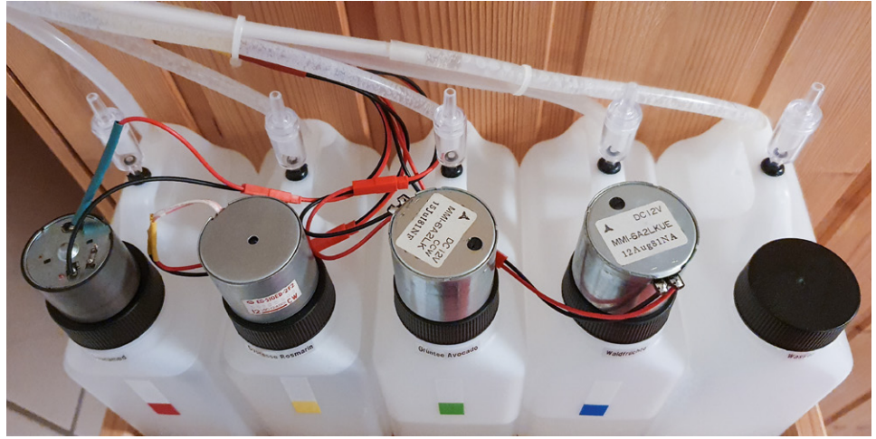
Bild 4: Detailansicht der Kanister mit Motoren und Schlauchzuführung
