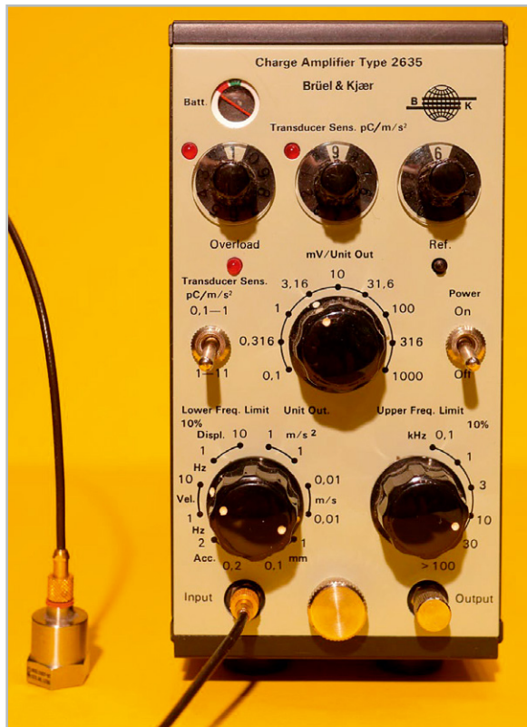
Bild 9: Beschleunigungsaufnehmer und Ladungsverstärker (Typ 2635 Brüel & Kjær) zur Messung von mechanischen Schwingungen, aber auch von Körperschall. Am Umschalter unten links erkennt man sehr deutlich die Schalterstellungen „Acc.“ (Beschleunigung), „Vel.“ (Schwingschnelle) und „Displ.“ (Auslenkung). Der Vorverstärker ist hier über ein 1,20 m langes Kabel und zwei Microdot-Stecker mit dem Vorverstärker verbunden.
