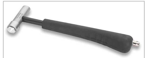
Bild 12: Impulshammer, der mit verschiedenen harten Spitzen (Stahl, Gummi, Kunststoff) ausgerüstet werden kann. (Foto: Brüel & Kjaer)
