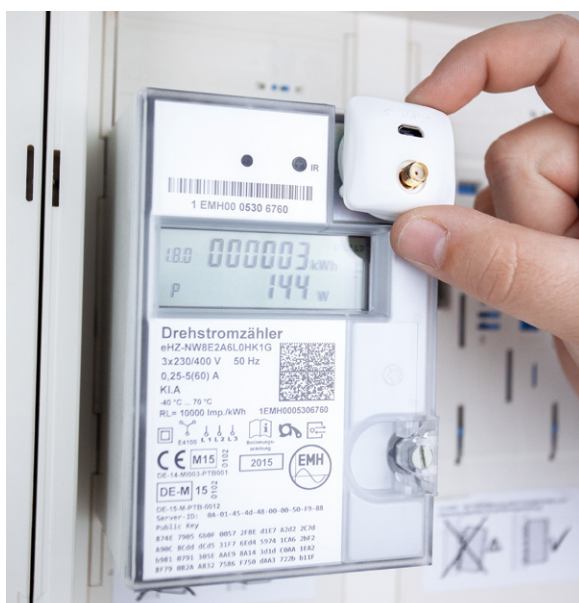
Bild 1: Beispiel für die Montage des poweropti an einem Energiezähler
