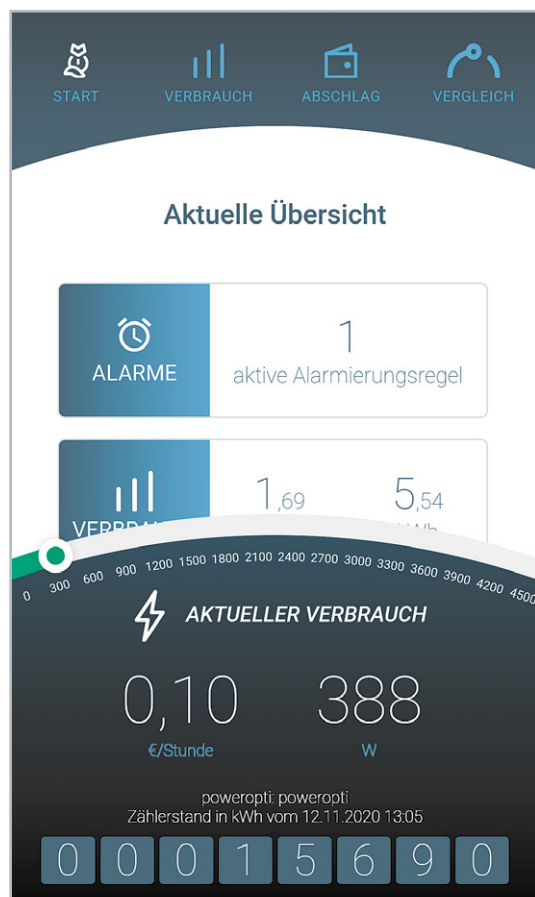
Bild 5: Anzeige der Leistungswerte und des Zählerstandes
