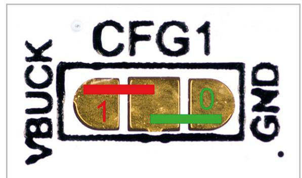
Bild 11: Konfiguration der Lötbrücken
