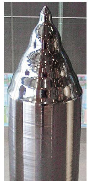
Bild 4: Kristalliner Siliziumstab
