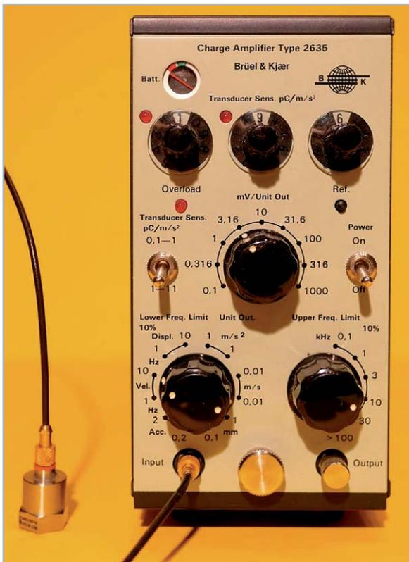
Bild 9: Beschleunigungsaufnehmer und Ladungsverstärker (Typ 2635 Brüel & Kjaer) zur Messung von mechanischen Schwingungen, aber auch von Körperschall. Am Umschalter unten links erkennt man sehr deutlich die Schalterstellungen „Acc.“ (Beschleunigung), „Vel.“ (Schwingschnelle) und „Displ.“ (Auslenkung). Der Vorverstärker ist hier über ein 1,20 m langes Kabel und zwei Microdot-Stecker mit dem Vorverstärker verbunden.
