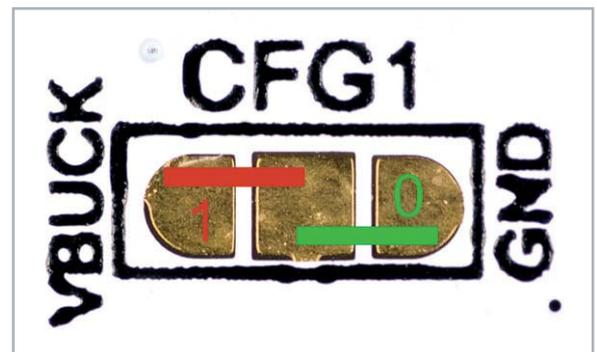
Bild 11: Konfiguration der Lötbrücken
