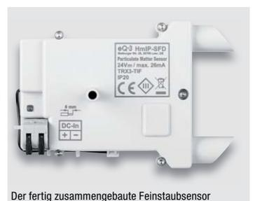
Der fertig zusammengesetzte Feinstaubsensor
