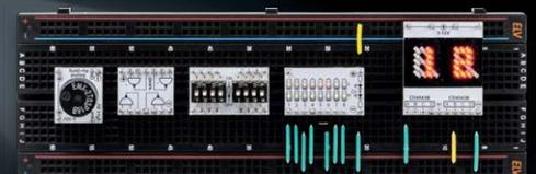
Prototypenadapter mit CMOS-Logik
