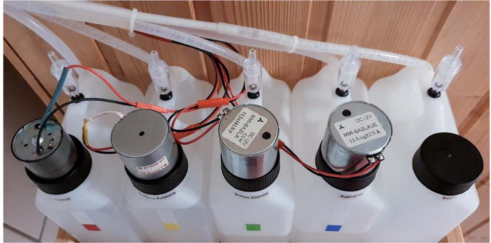
Bild 4: Detailansicht der Kanister mit Motoren und Schlauchzuführung
