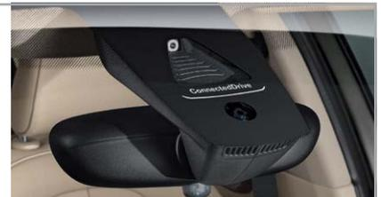
Kombination aus Kamera und Short-Range-Lidar
