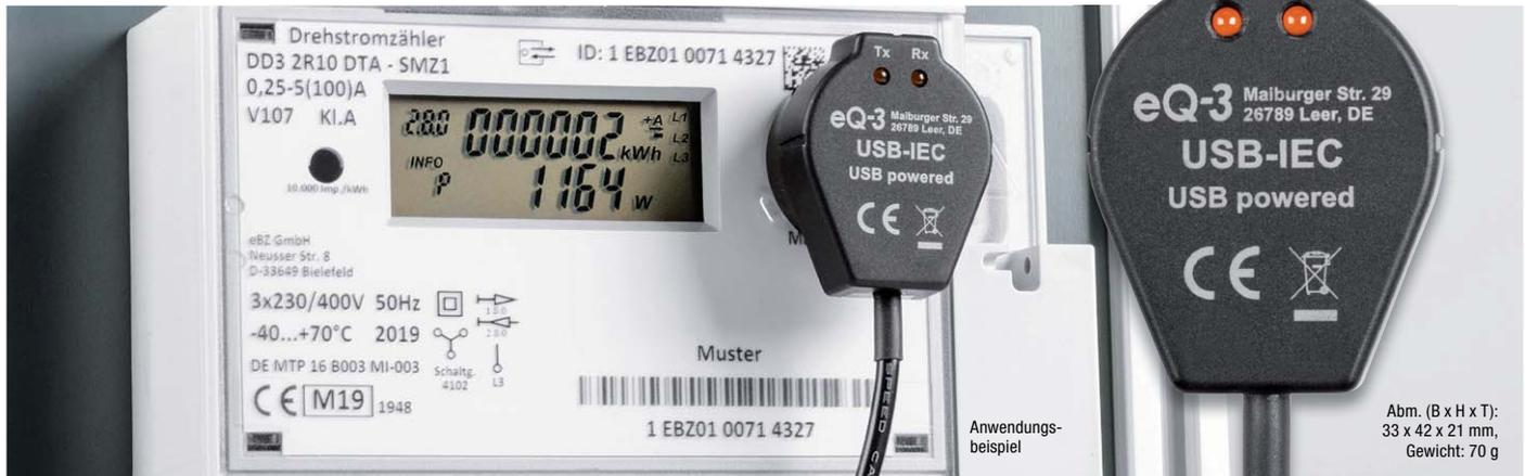
Das Fernauslesen des Stromzählers ist die bequeme und komfortable Variante, den Überblick über den Stromverbrauch im Haus zu erhalten. Die aufbereiteten Daten kann man dann einfach an einer zentralen Stelle anzeigen lassen und über Softwareprogramme beispielsweise grafisch visualisieren und analysieren.
