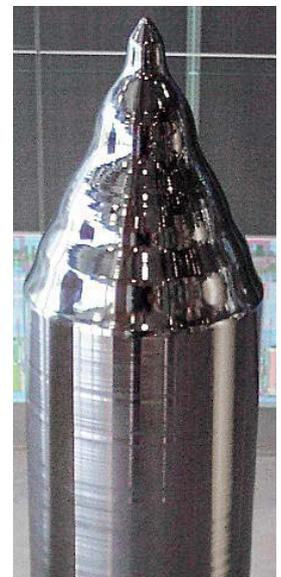
Bild 4: Kristalliner Siliziumstab
