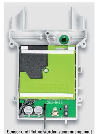
Sensor und Platine werden zusammengesetzt
