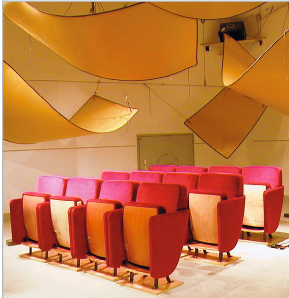
Bild 12: Messaufbau zur Bestimmung des Schallabsorptionsgrads einer Bestuhlung in einem Hallraum Foto: Müller-BBM GmbH, 82152 Planegg
