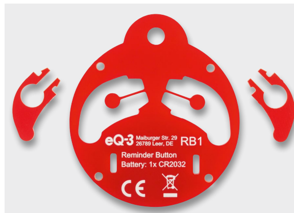
Bild 6: So werden die Standfüße herausgebrochen.
