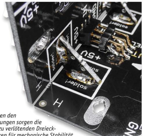
Bild 4: Neben den Verschraubungen sorgen die sorgfältig zu verlötenden Dreieckstabilisatoren für mechanische Stabilität.
