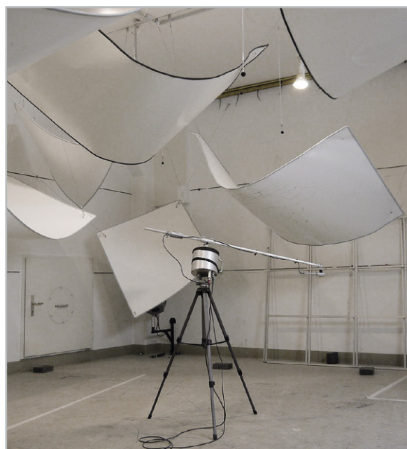
Bild 11: Typischer Hallraum mit eingehängten Diffusoren zur Erhöhung der Diffusität. Im Vordergrund befindet sich ein Messmikrofon an einem drehbaren „Galgen“ zur räumlichen Mittelung der Messwerte. Foto: Müller-BBM GmbH, 82152 Planegg
