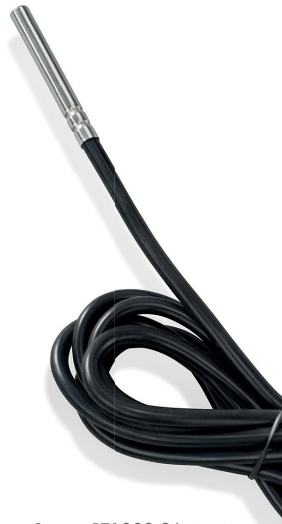
Sensor PT1000 2-Leiter im Lieferumfang enthalten Sensorleitung: 2 Meter (bis zu 50 m verlängerbar)
