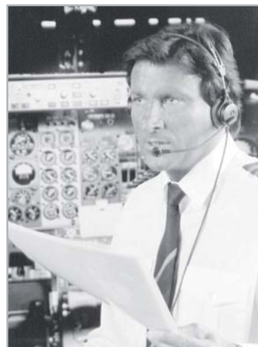
Bild 10: Praktische Ausführung einer Hör-/Sprechgarnitur mit aktiver Geräuschkompensation im Cockpit-Einsatz (Typ HME 45 aus der Anfangszeit dieser Technik). Es handelt sich hier um eine akustisch offene Kopfhörerkapsel, an der man deutlich das Mikrofon zur Geräuschaufnahme erkennt. (Foto: Sennheiser electronic)
