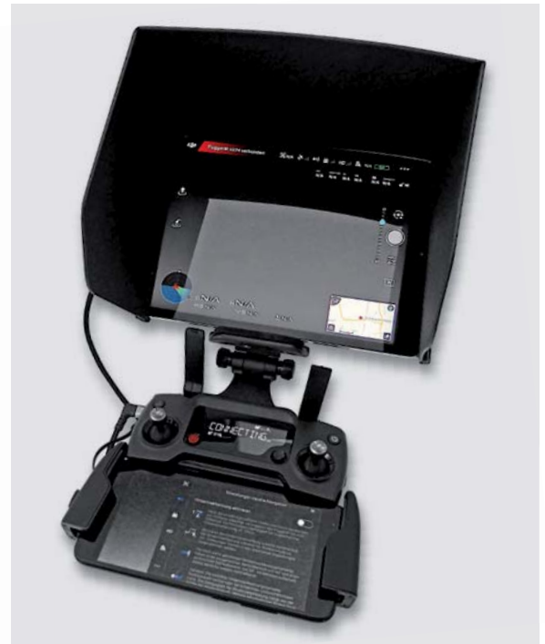
Bild 14: Erst mit der App entfaltet die Drohne ihre wahren Möglichkeiten. Dazu wird das Smartphone oder ein Tablet an der Fernbedienung befestigt und per Kabel mit dieser verbunden. Ein Blendschutz unterstützt bei starker Sonneneinstrahlung.
