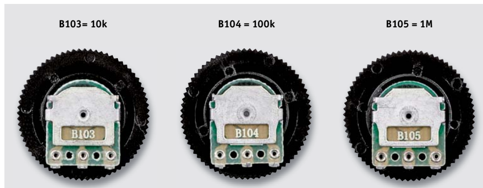
Bild 17: Die Widerstandswerte sind kodiert aufgedruckt.
