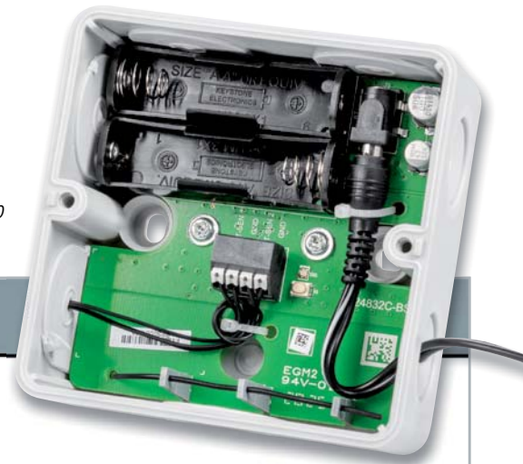
Bild 1: 2-fach-Temperatursensor mit optionaler Spelsberg-Abox 040
