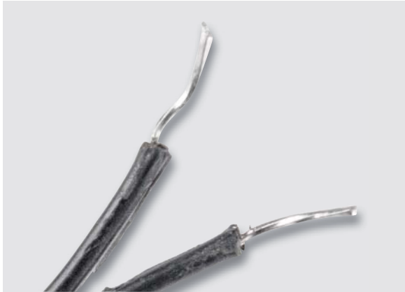
Bild 8: Auftrennen und Abisolieren der Zillingskabel am Ende
