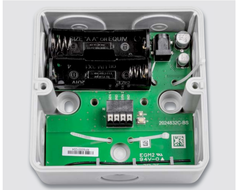
Bild 9: Montage der Kabelbinder (hier mit optional erhältlicher Abox 040)
