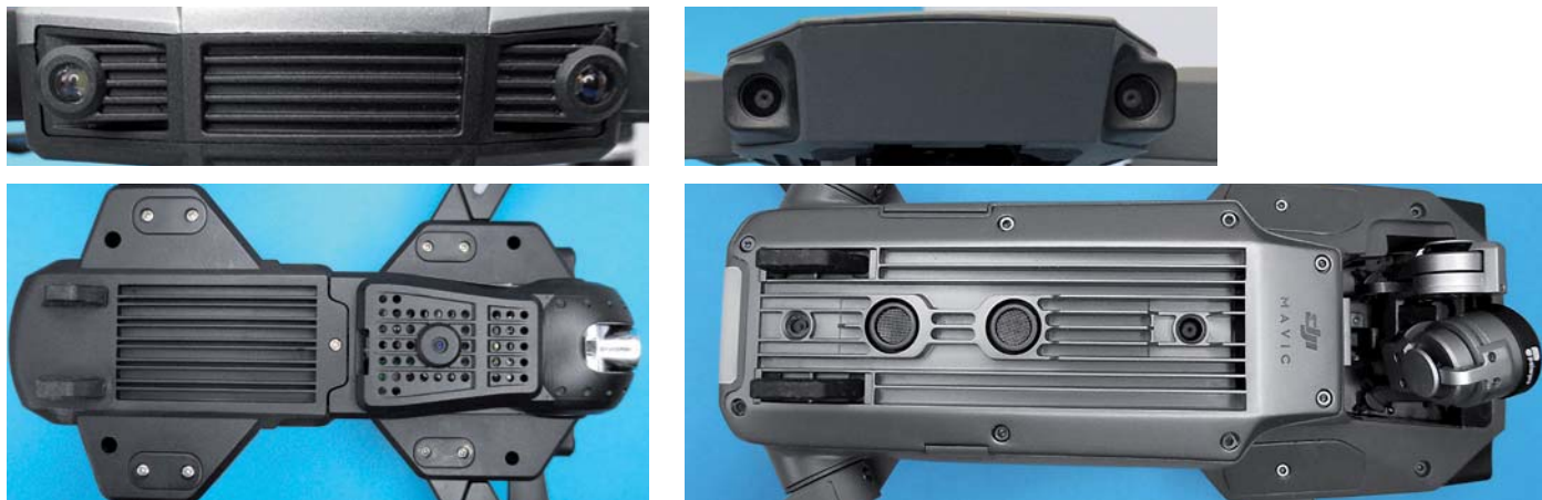
Bild 27: Komplexe Sensorausstattung für Hinderniserkennung und Orientierung oder einfacher Distanzsensor – auch darin unterscheiden sich die Drohnenklassen. Links eine einfach ausgestattete Drohne der 250-Euro-Preisklasse, diese trägt an der Front nur LEDs. Rechts die Sensoren der Mavic Pro. Hier gibt es zusätzlich Sensoren für die Hinderniserkennung nach vorn.
