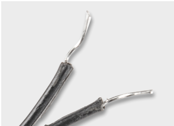
Bild 8: Auftrennen und Abisolieren der Zwillingskabel am Ende
