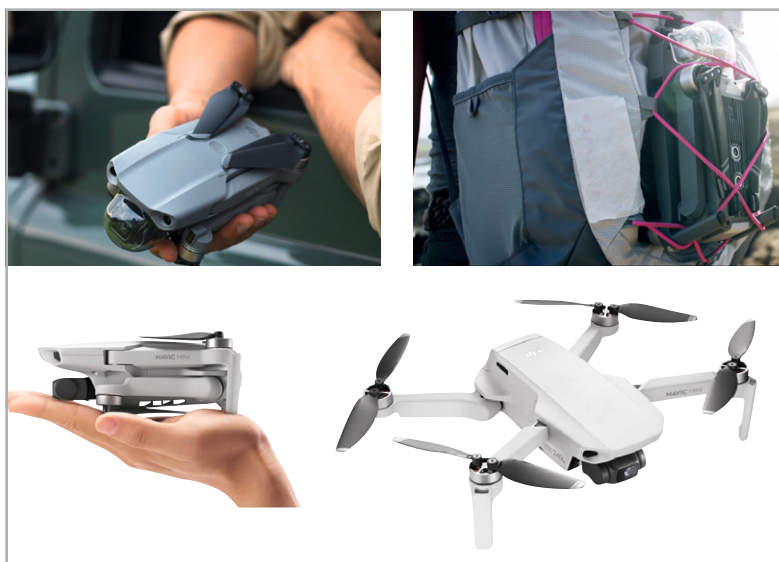
Bild 6: Superkompakt zusammengeklappt – die MavicIC Klappdrohnen lassen sich einfach transportieren. Unten im Bild ist die 249-g-Drohne Mavic Mini zu sehen. Bilder: DJI
