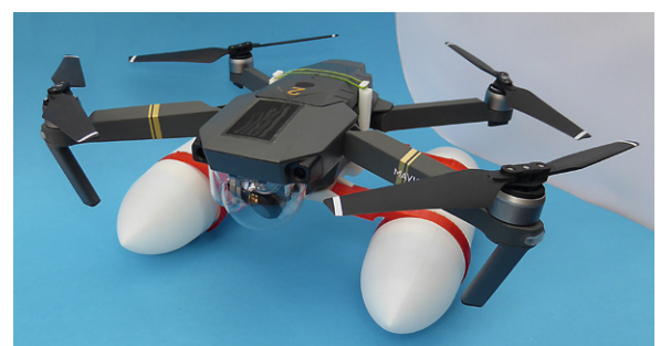
Bild 11: Ein passendes Wasserlandegestell, hier aus dem 3D-Drucker, gibt Sicherheit bei Flügen über Gewässern und ermöglicht sogar das Starten und Landen auf dem Wasser.
