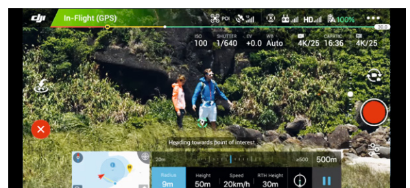
Bild 17: Im Point-of-Interest-Modus umkreist umkreist die Drohne selbstständig ein Ziel, die Kamera ist auf dieses gerichtet. Bild: DJI
