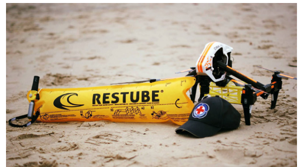
Bild 2: Drohnen können Leben retten – hier eine DJI Inspire der DRK-Wasserwacht in Mecklenburg-Vorpommern. Auch die DLRG nutzt solche Drohnen, die Rettungs- und Markierungsmittel bei Wasserrettungsaktionen abwerfen können.
