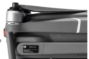
Bild 3: Fliegt die Drohne weg bzw. verursacht sie etwa bei einem Absturz einen Schaden, lässt sich der Besitzer anhand der vorgeschriebenen wasser- und feuerfesten Kennzeichnungsplakette ermitteln. Bild: DJI
