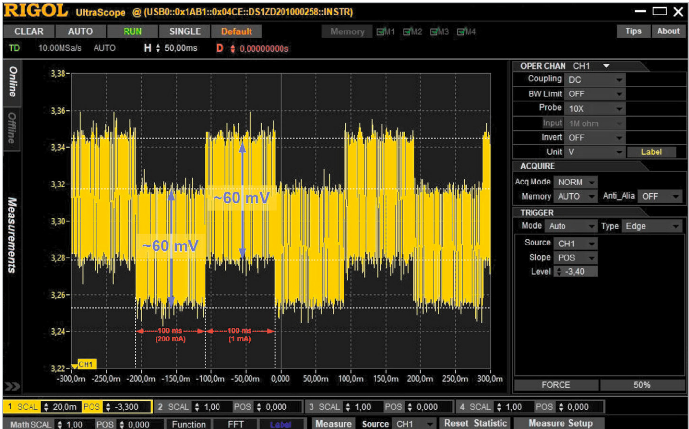
Bild 3: Periodische Laststromsprünge im 100-ms-Intervall zwischen 1 mA und 200 mA haben nur einen minimalen Einfluss auf die Ausgangsspannung. Die der Ausgangsspannung überlagerten Störspannungen (Ripple) ändern sich praktisch nicht.
