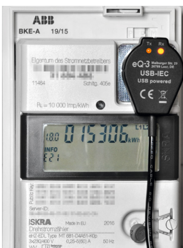
Bild 1: Der USB-IEC an einem Stromzähler Iskra MT681 mit aktivierter optischer Schnittstelle
