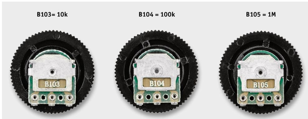
Bild 17: Die Widerstandswerte sind kodiert aufgedruckt.
