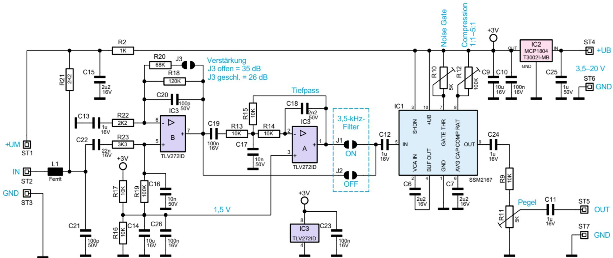
Bild 3: Schaltbild des Mikrofonverstärkers
