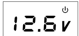
**Hinweis: Während des normalen Betriebs schaltet sich die Hintergrundbeleuchtung des Displays nach ca. 1 Minute aus. Um die Hintergrundbeleuchtung einzuschalten, drücken Sie die Wahltaste NUR EINMAL kurz.**
