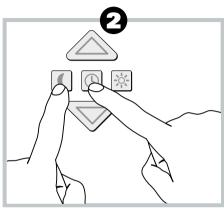
Wert wird gespeichert und durch kurzes Aufblinken des Mondsymbols bestätigt. Nutzen Sie die Dämmerungsautomatik, so wird das automatische Herabfahren durch die Zeitautomatik (dauerhaft) deaktiviert.
