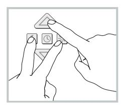
Durch gleichzeitiges Drücken der Tasten [Sonne] + [Mond] mit anschließendem Druck auf die [Auf]-Taste kann zwischen 3 Modi gewählt werden:
