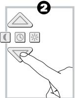
2 Senken des Rollladen Kurz die [Ab]-Taste betätigen und der Gurtwickler senkt den Rollladen bis zur unteren Endlage.
