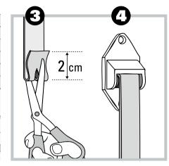
3 Gurtband am Ende (ca. 2-3 cm) doppelt legen und mit einer Schere einen Schlitz für die spätere Montage am Wickelrad schneiden.
