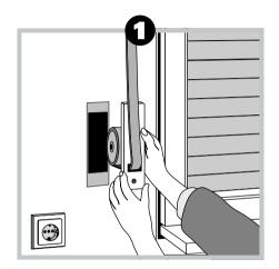
• Den alten Gurtwickler entfernen: Rollladen ganz herunterlassen, Gurtwickler ausbauen und Gurtband abwickeln.
