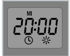
Die Beleuchtung des Gurtwicklers schaltet sich bei Bedienung für 15 Sekunden ein. Wird der Gurtwickler nicht mehr bedient geht die Beleuchtung innerhalb von fünf Sekunden langsam gedimmt wieder aus.
