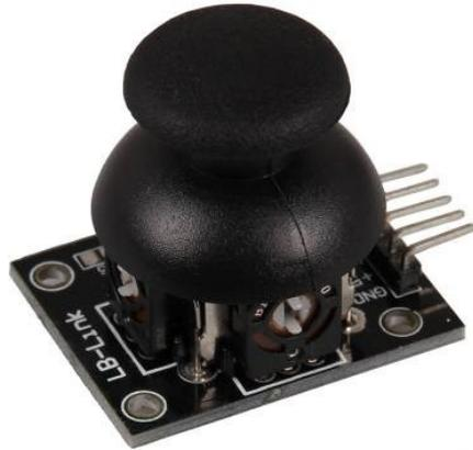
Für die Verwendung des Joysticks benötigen Sie zusätzlich den ADC.
