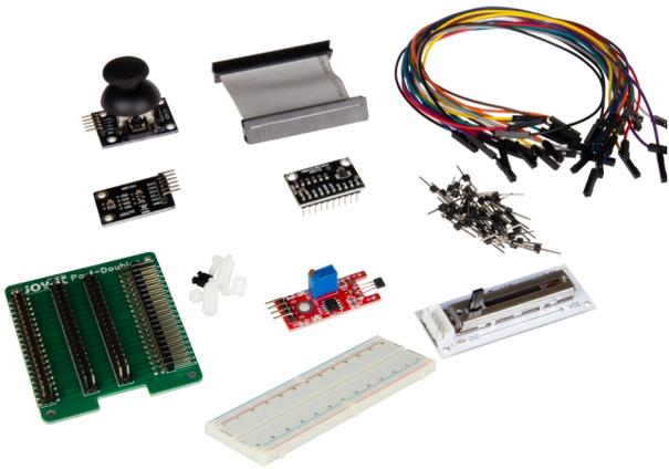
Das Erweiterungsset fügt Ihrem Experimentierkoffer 5 weitere Sensoren und Module hinzu. Die benötigten Anschlüsse dafür stellt die Port-Doubler-Platine bereit.
