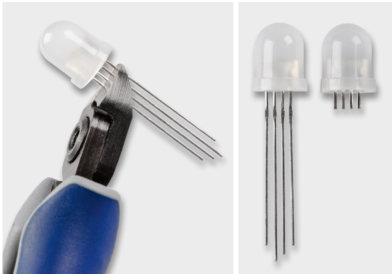
Bild 5: So sind die LED-Anschlüsse der WS2812 zu kürzen.
