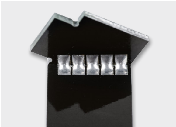
Bild 11: Innenseite der verlötete Abdeckkappe
