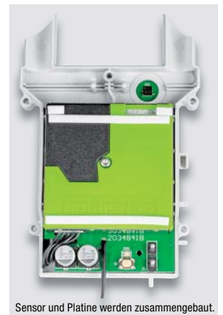
Sensor und Platine werden zusammengesetzt.
