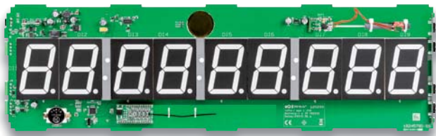
Oberseite der bestückten Platine der LSU200 mit bestücktem optionalem Funkmodul HmIP-MOD-OC8
