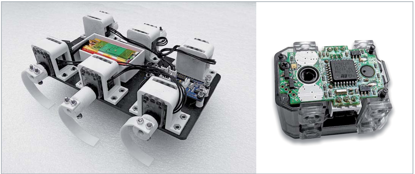
Bild 13: Der aufgebaute MiniHex und die dabei verwendeten Dynamixel-Antriebe. Im Bild fehlt nur noch die Bluetooth-Option für die drahtlose Fernsteuerung. Rechts ein einzelner Antrieb mit der integrierten Regelelektronik.
