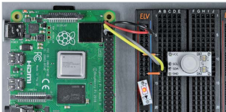
Bild 9: Anschluss des SHT20 mit optionaler LED zur Anzeige der Spannungsversorgung
