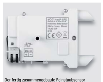
Der fertig zusammengesetzte Feinstaubsensor
