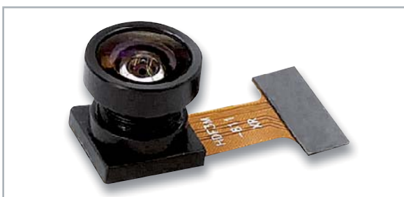
Bild 5: An das ESP32-CAM-Board können auch andere Kameras angeschlossen werden, hier ein Modell mit Fischaugen-Objektiv. Bild: Omnivision
