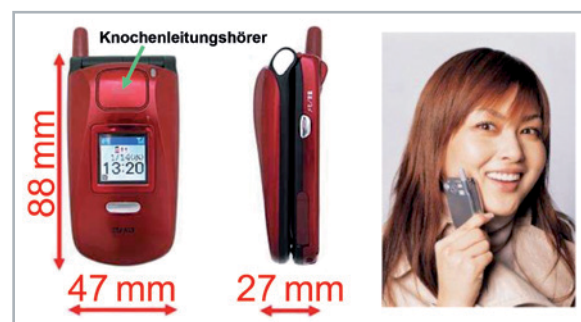
Bild 11: Beispiel für ein Mobiltelefon (Typ TS 4, Sanyo) mit eingebautem Knochenleitungshörer. Das Telefon kann man sich an die Stirn, an die Wange oder an eine andere Stelle des Kopfes halten, und die Gehörgänge bleiben dabei offen.
