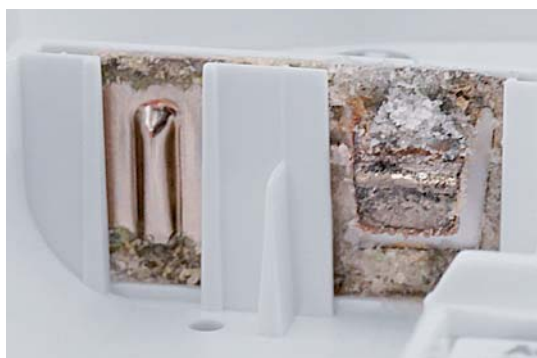
Bild 12: Kaliumcarbonat-Ablagerungen am Batteriekontakt
