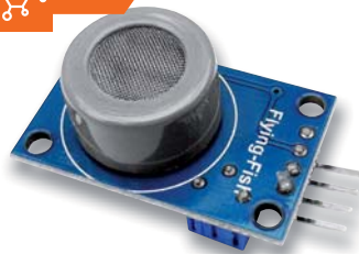
Bild 7: Der CO-Sensor MQ7 mit Anschlussbelegung des Breakout-Boards
