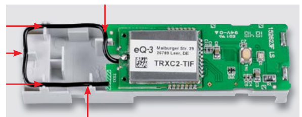
Bild 9: So wird die Antenne in die Antennenhalter eingelegt.
