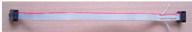
Bild 3: Die Adern 2 und 5 werden aufgetrennt und zu den Jumpers geführt.
