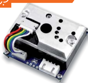
Bild 8: Der Feinstaubsensor Sharp GP2Y-1010AU0F mit Anschlussbelegung des Breakout-Boards. Bild: Waveshare
