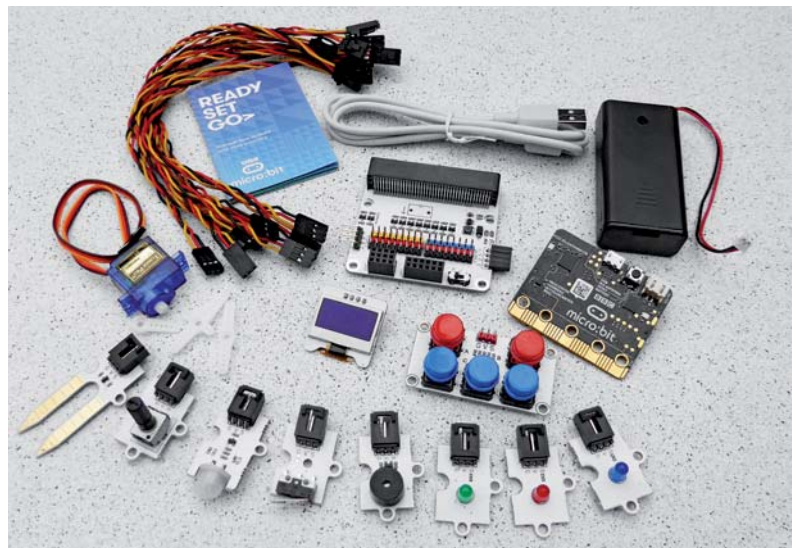
Bild 15: Umfangreiches Set mit gutem Tutorial – das Velleman-micro:bit-Tinker-Kit
