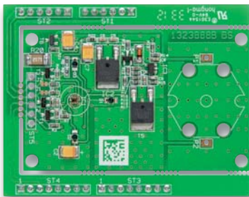
Bild 16: Der Gestensensor GLD1 von ELV als Arduino-Shield mit dem Si1143
