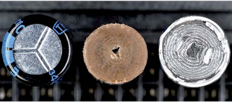
Bild 13: Original Kondensator (li.), ohne Becher (Mitte) und im Querschnitt (re.)
