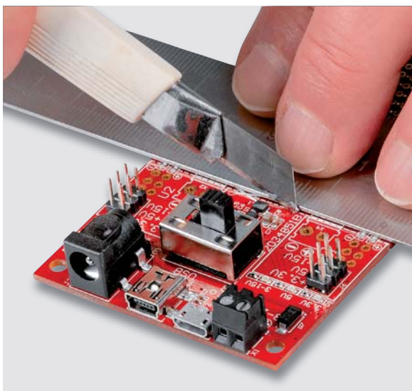
Bild 19: So wird die Platine mit einem Cuttermesser eingeritzt.
