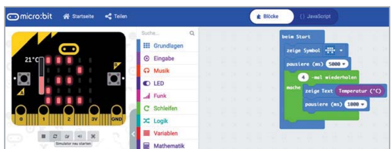
Bild 7: Ein einfaches Programm, hier für den Abruf der Temperatur des bordeigenen Temperatursensors, ist schnell erstellt und simuliert.
