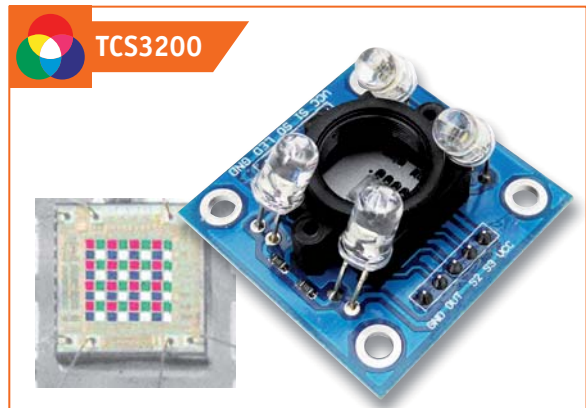
Bild 24: Der Farbsensor TCS3200 von Ams. Links ist die Aufteilung der Fotodioden im Array zu sehen.
