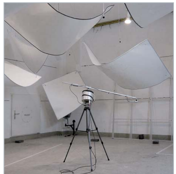
Bild 8: Hallraum mit eingehängten Diffusoren und rotierendem Messmikrofon, z. B. zur Bestimmung der Absorptionseigenschaften von Schallschluck-Materialien
