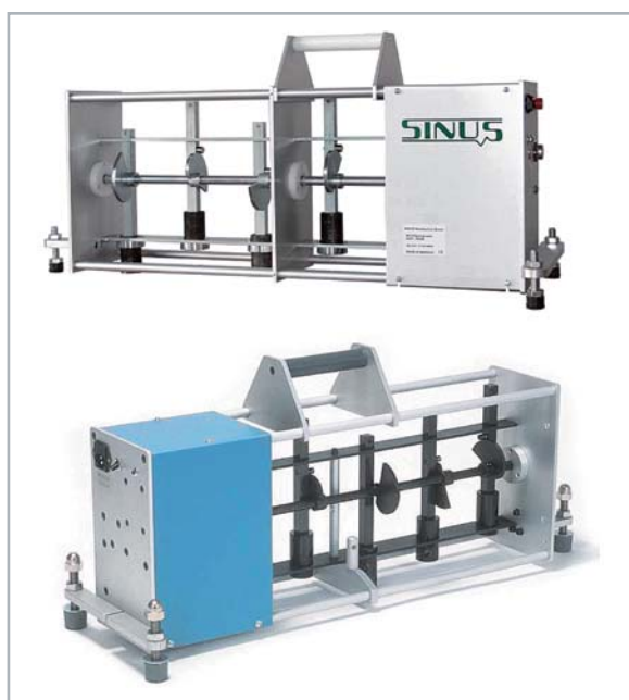
Bild 11: Norm-Trittschallhammerwerk (zwei Ausführungsbeispiele)
