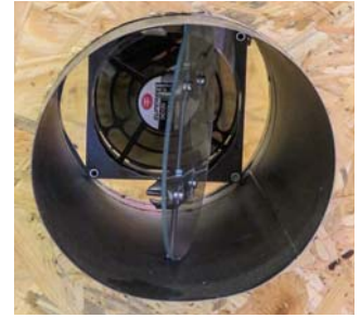
Bild 2: Hier noch im Bau – die Belüftungseinheiten mit servogesteuerter Lüftungs-klappe und altem PC-Lüfter. Bild: Pfeiffer
