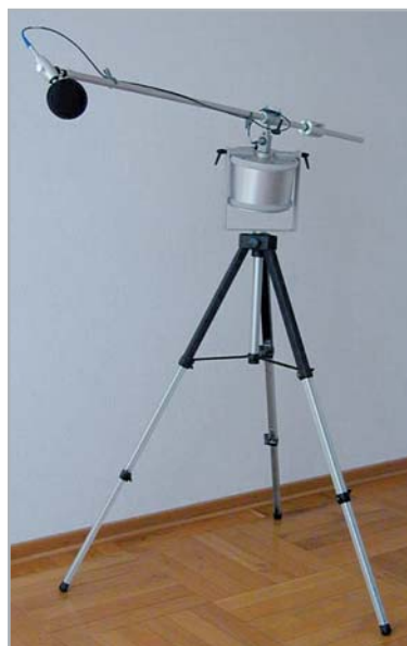
Bild 7: Messmikrofon, montiert an einem drehbaren „Galgen“, wie es häufig in der Bauakustik zur Anwendung kommt
