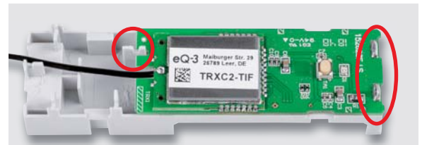
Bild 8: Die mit den Batteriekontakten voran in das Gehäuseunterteil eingesetzte Platine
