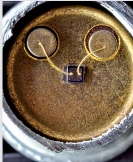
Bild 10: Der kleine Bruder vom 2N6253 mit immerhin noch maximal 600 mA Kollektorstrom
