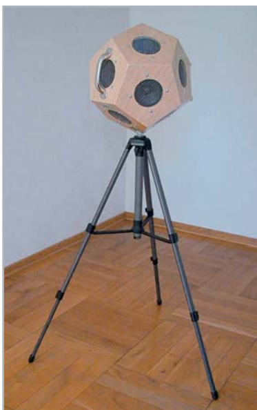
Bild 6: Typischer Messlautsprecher für den Einsatz in der Bauakustik mit 12 Einzellautesprechern (Dodekaeder)
