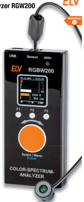
Abm. (B x H x T): 62 x 142 x 25 mm, Sensor: 16 x 16 mm, Gewicht: 157 g (inkl. Batterien)
