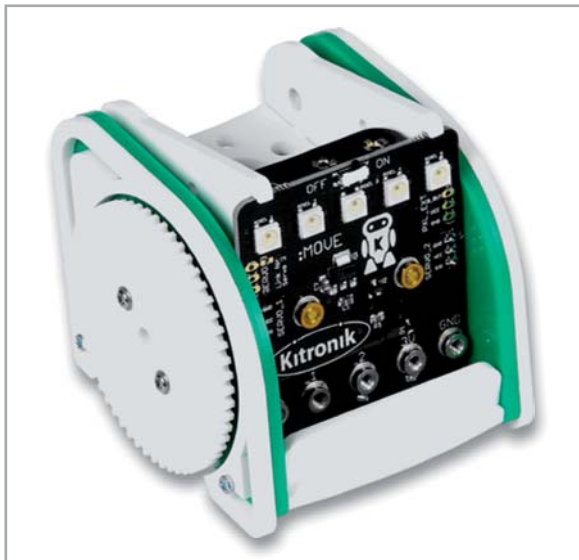
Bild 16: Der Roboter-Bausatz „Move Mini Buggy“ von JOY-iT basiert auf dem BBC micro:bit.
