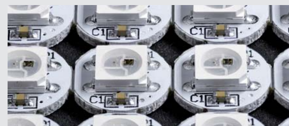
Bild 6: WS2812-LEDs gibt es in verschiedenen Ausführungen.
