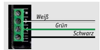
Bild 3: So erfolgt der Anschluss des mitgelieferten UART-USB-Kabels.
