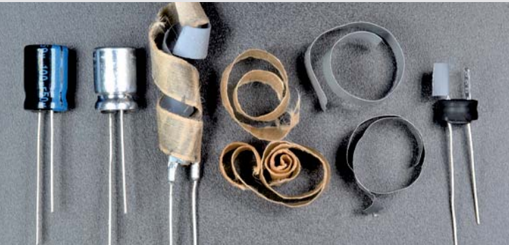
Bild 14: Gut sichtbar sind hier die einzelnen Bestandteile des Elektrolytkondensators.
