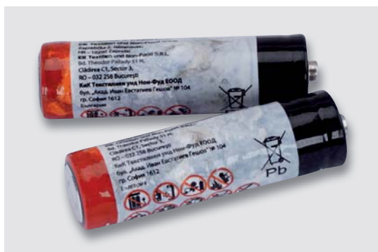
Bild 13: Typische Gehäusekorrosion von Zink-Kohle-Batterien
