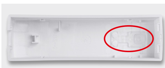
Bild 10: Der Lichtleiter, der gleichzeitig als Tasterstößel dient, ist bereits ab Werk montiert.
