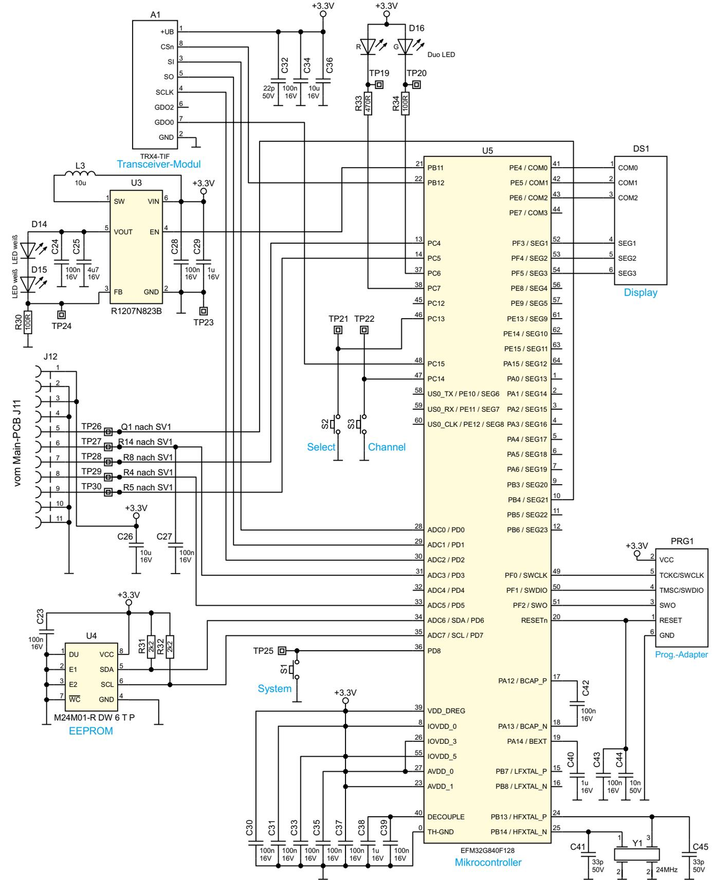
Bild 1: Schaltbild der Displayplatine (Display-PCB)
