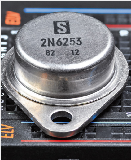
Bild 9: Der Leistungstransistor 2N6253, der maximal 15-A-Kollektorstrom schalten kann
