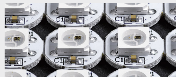
Bild 6: WS2812-LEDs gibt es in verschiedenen Ausführungen.
