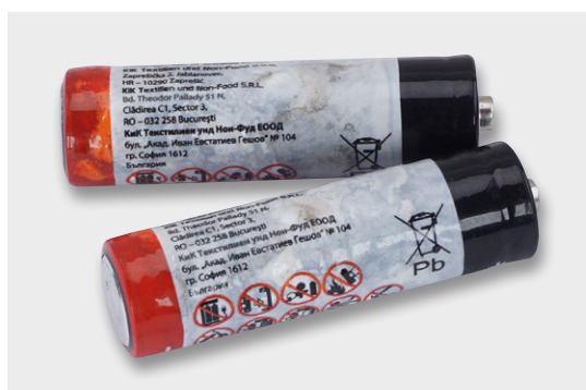
Bild 13: Typische Gehäusekorrosion von Zink-Kohle-Batterien
