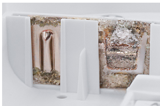
Bild 12: Kaliumcarbonat-Ablagerungen am Batteriekontakt
