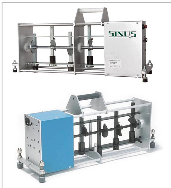
Bild 11: Norm-Trittschallhammerwerk (zwei Ausführungsbeispiele)
