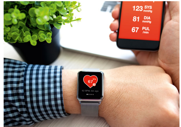
Optische Health-Sensoren in Smart Watches erfassen z. B. Puls- und Blutdruckwerte sowie die Sauerstoffkonzentration im Blut.
