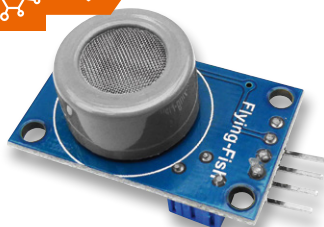
Bild 7: Der CO-Sensor MQ7 mit Anschlussbelegung des Breakout-Boards
