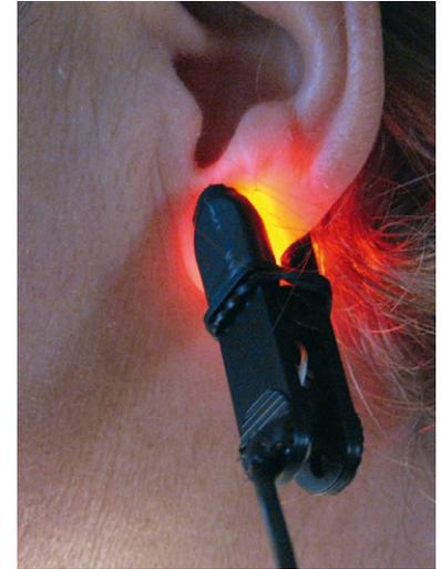
Bild 7: Pulssensor am Ohr
