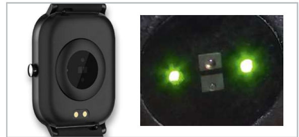
Bild 9: Der Kombisensor auf der Rückseite der Uhr. Für Messungen am Handgelenk hat sich schmalbandiges grünes Licht bewährt.
