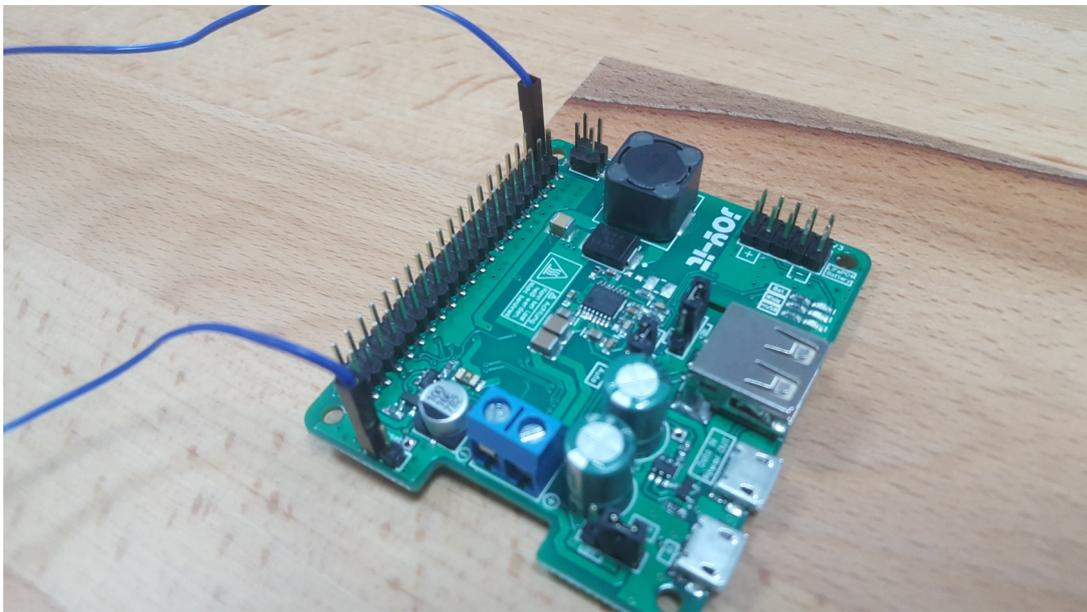
Man kann auch jeden anderen GPIO-Pin verwenden, allerdings muss dafür die Software dementsprechend angepasst werden.
