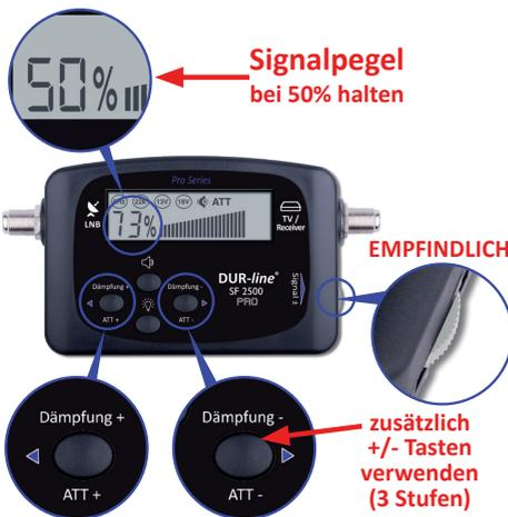
Den Signalpegelanzeigebereich durch Verringern oder Steigern der Dämpfung bei ca. 50% halten. So kann eine Pegelzu- oder Abnahme erkannt werden. Bei aktivierter Dämpfung erscheint im Display „ATT“.
