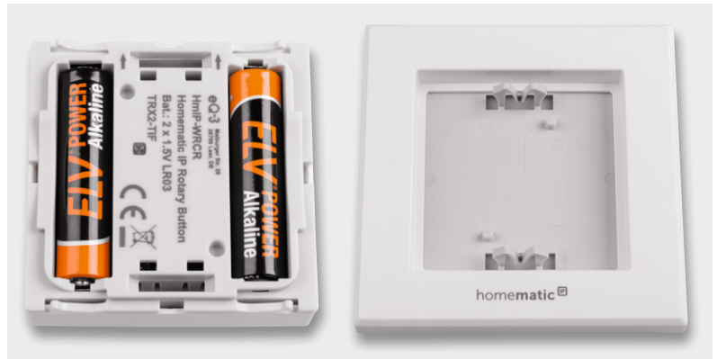
Bild 9: Das mit Batterien bestückte Gerät kann in den zugehörigen Montage- rahmen eingesetzt werden.
