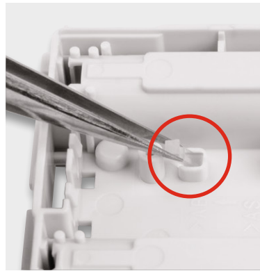
Bild 5: Zur Vorbereitung der Gehäusemontage sind zunächst die im Bild links zu sehenden Distanzstifte abzuschneiden sowie der Lichtleiter, wie im Bild rechts gezeigt, einzusetzen.
