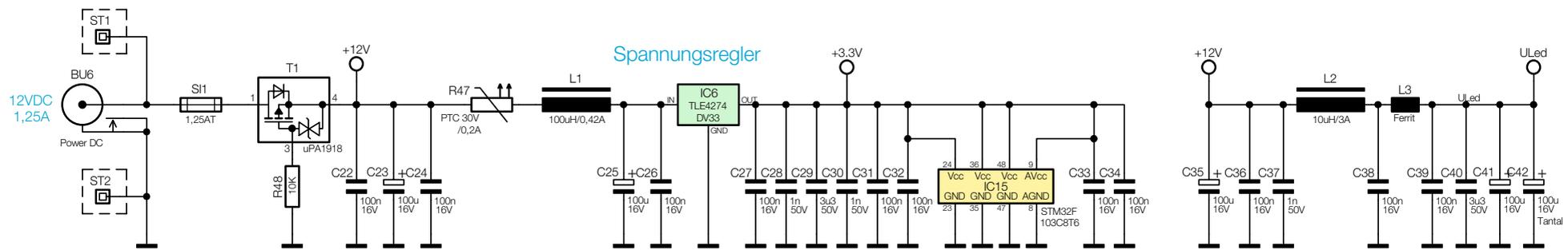
Bild 3: Das Schaltbild der Spannungsversorgung der LSU200
