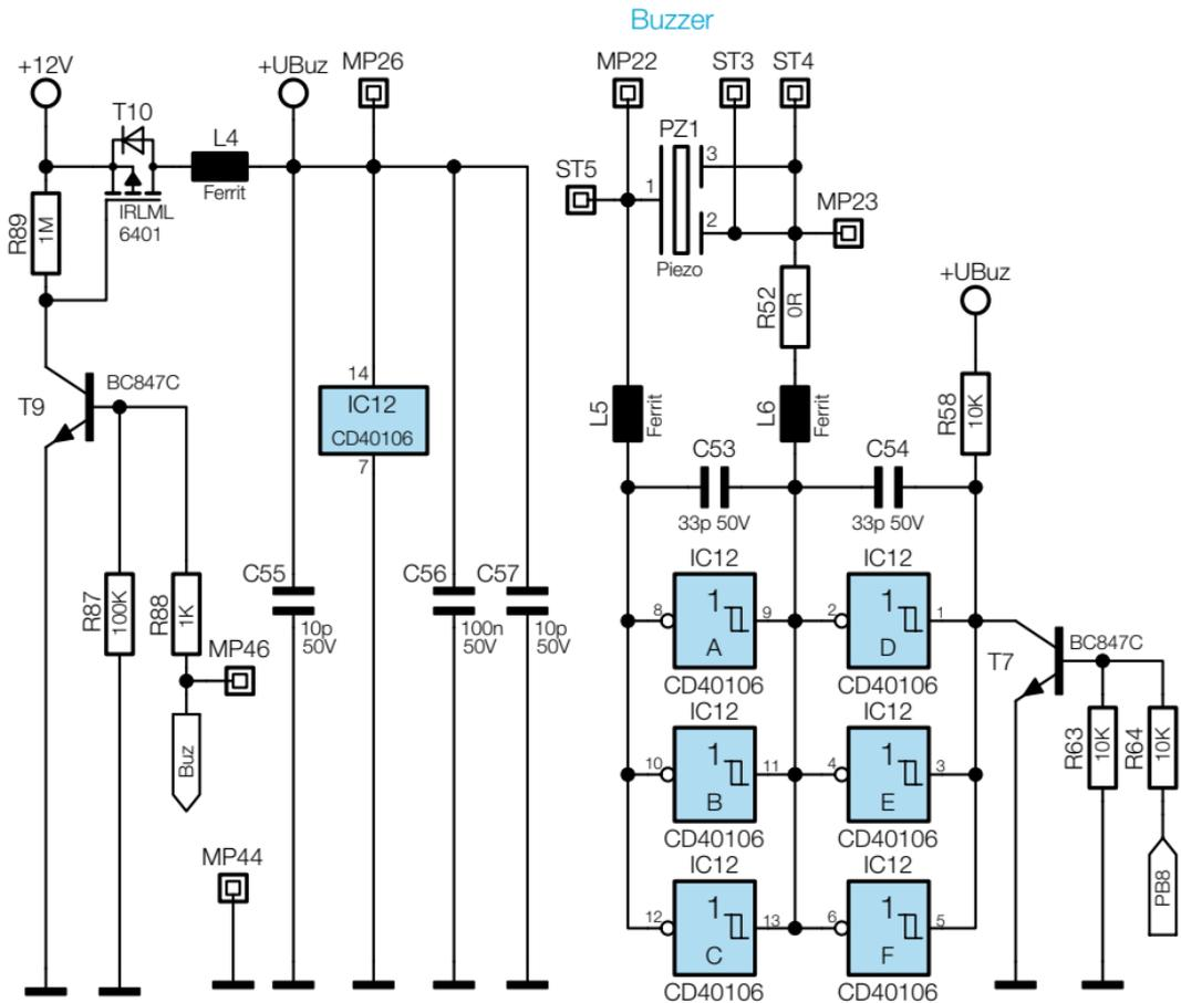
Bild 4: Das Schaltbild der Ansteuerung des Piezosignalgebers
