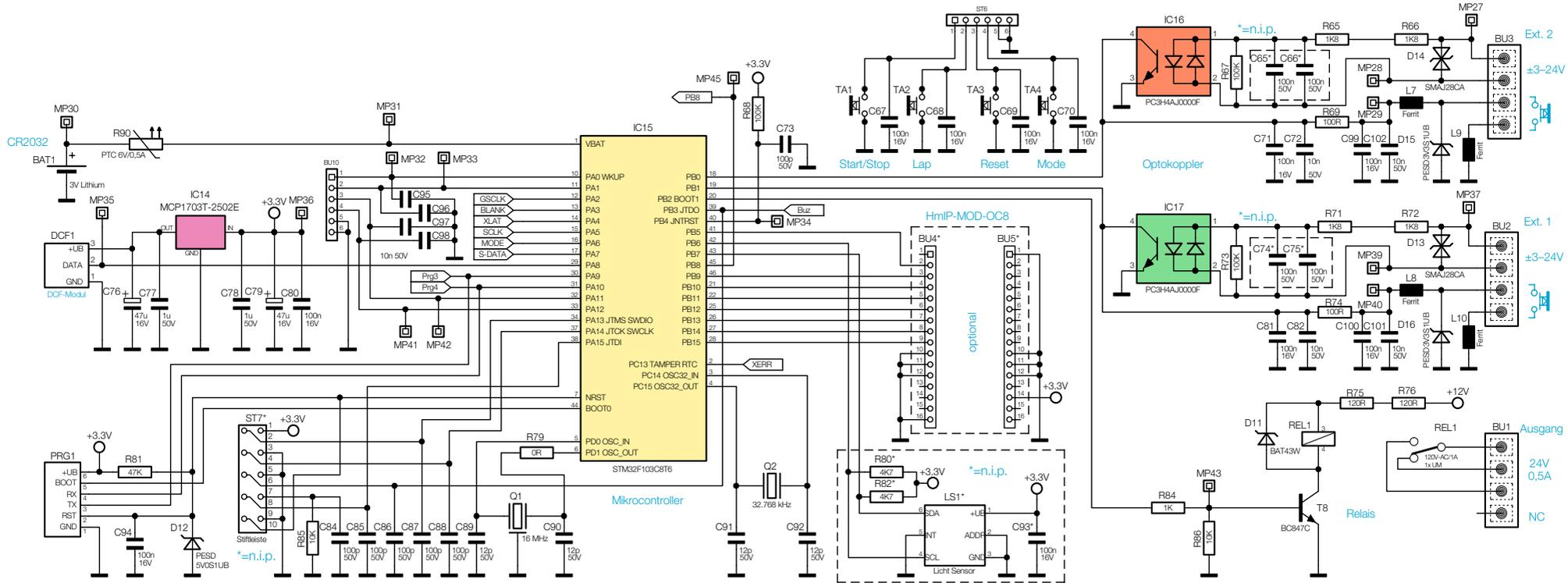
Bild 2: Das Schaltbild der Mikrocontroller-schaltung mit DCF77-Empfänger, Tastaturplatine, externen Eingängen, Relaisausgang und optionalem Homematic IP Funkmodul
