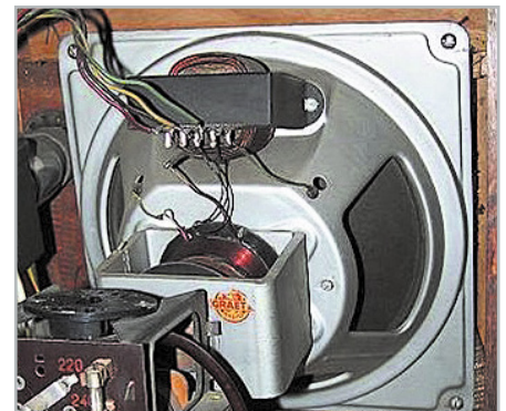
Bild 2: Fremderregter elektrodynamischer Lautsprecher, ohne Permanentmagneten, verwendet in alten Röhrenradios. Im oberen Bild erkennt man die Erregerwicklung, die die Funktion der Siebdrossel im Netzteil übernahm und dabei vom gesamten Gleichstrom des Gerätes durchflossen wurde. Dieser Strom reichte aus, um dem Lautsprecher ein für die Bewegung der Membran ausreichendes Magnetfeld bereitzustellen.
