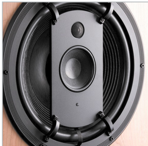
Bild 9: 3-Wege-Lautsprecher mit nierenförmiger Richtcharakteristik im Bassbereich (Typ RL 901 K). Tiefton- und Mitteltonlautsprecher besitzen eine Konusmembran. Übertragungsbereich: 25 Hz–20 kHz ( \pm 3 dB). (Quelle: Musikelectronic Geithelm GmbH)
