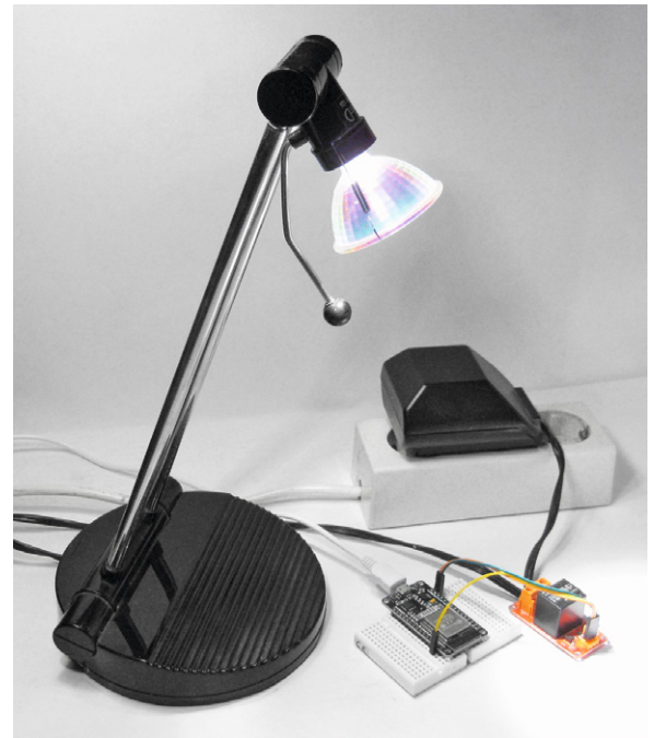
Bild 4: Schalten einer 12-V-Halogenlampe via ESP32 und Relaismodul
