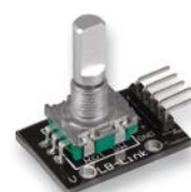
Steckbrettlösungen wie diese haben keine hohe Zuverlässigkeit, da die Kontakte sich beim Bedienen des Inkrementalgebers bewegen können.
