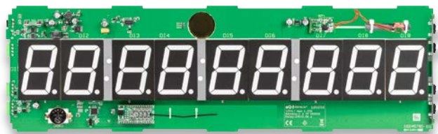
Oberseite der bestückten Platine der LSU200 mit bestücktem optionalem Funkmodul HmIP-MOD-OC8
