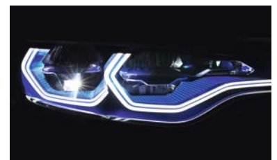
Bild 23: Typisches Leuchtbild bei der Beleuchtung über Prismenstäbe. Bild: BMW
