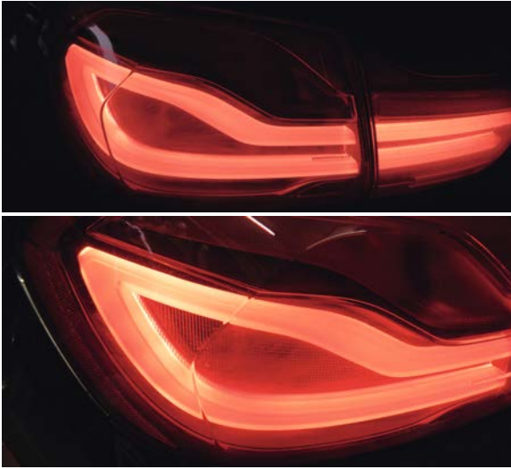
Bild 25: Durchstrahlte, dreidimensionale Leuchtkörper ergeben ein plastisches, glühend erscheinendes Leuchtbild mit Tiefeneffekt.
