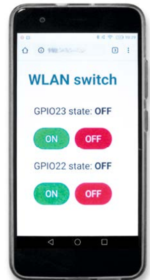
Bild 4: Schalten einer 12-V-Halogenlampe via ESP32 und Relaismodul
