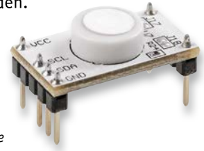
Die mit dem SHT20 aufgebaute Temperatur-Feuchte-Sensor-Platine
