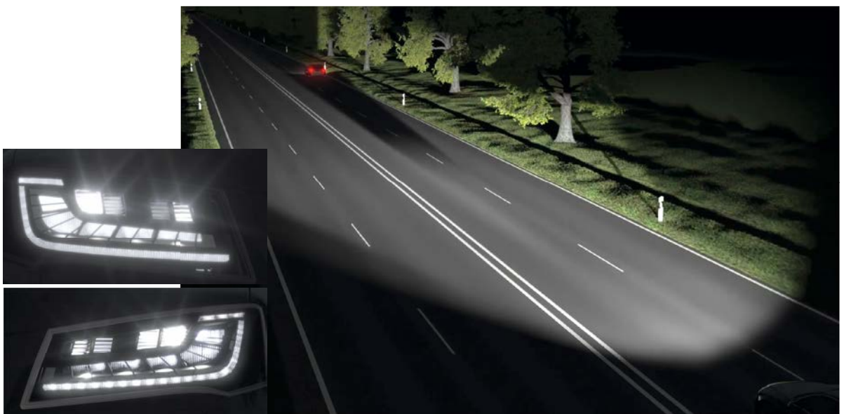
Bild 10: Erfasst die Kamera die Rückleuchten eines vorausfahrenden Fahrzeugs, wird abgeblendet und die Hell-Dunkel-Grenze hinter dem Vorausfahrer kontinuierlich bei der Annäherung abgesenkt. Bild: HELLA
