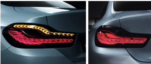
Bild 27: OLED-Technik ermöglicht eine völlig neuartige, dreidimensional gestaffelte Leuchtengestaltung – hier an einem Versuchsfahrzeug. Bilder: BMW
