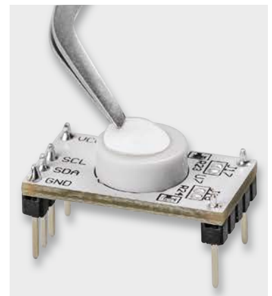
Bild 8: So wird die Membrane auf die Plastikkappe des Sensors aufgeklebt.
