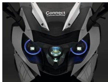
Bild 23: Typisches Leuchtbild bei der Beleuchtung über Prismenstäbe. Bild: BMW
