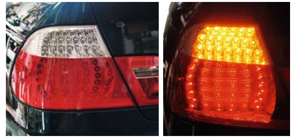
Bild 1: Eine der ersten Voll-LED-Rückleuchten, die Anfang der 2000er-Jahre auf den Markt kamen.
