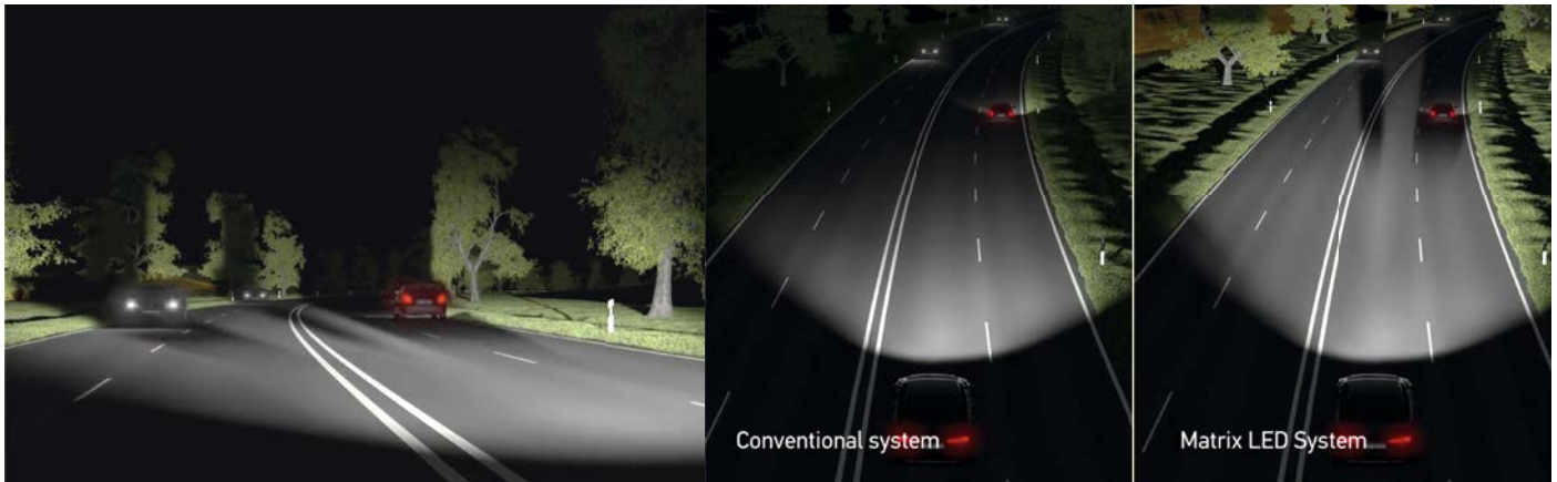
Bild 11: Entgegenkommende Fahrzeuge werden erfasst und dynamisch aus dem Lichtkegel ausgeblendet. Der Vergleich rechts im Bild zeigt deutlich den Sichtfeldgewinn beim Matrix-LED-System: Vorfeld und Seitenstreifen sind stets voll beleuchtet. Bild: HELLA
