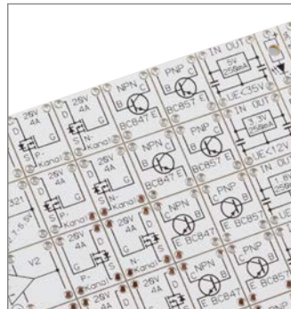
Platinen werden als Nutzen geliefert
