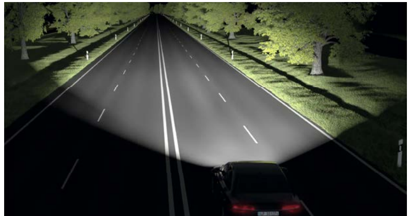
Bild 8: Ein Matrixscheinwerfer wie in Bild 5 gezeigt in voller Aktion, rechts das dabei entstehende typische breite und weitreichende Lichtbild (Landstraßenlicht). Bild: HELLA
