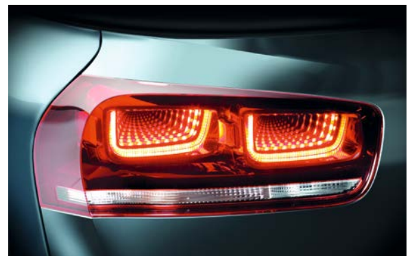
Bild 3: LED-Technik bietet völlig neue Gestaltungsmöglichkeiten, hier eine Citroen-Picasso-Heckleuchte in Lichttunneloptik. Bild: HELLA
