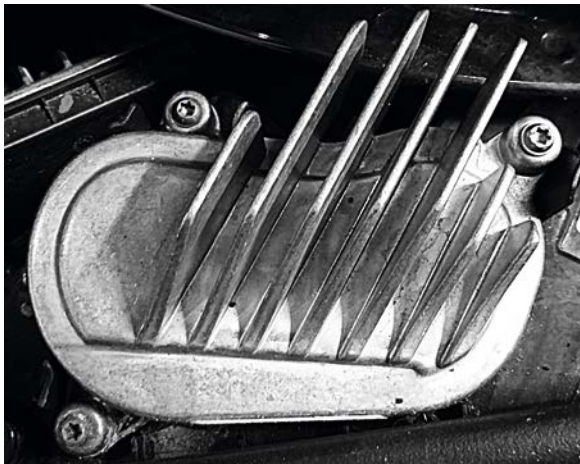
Bild 6: Kennzeichen für leistungsstarke LED-Beleuchtung – großer Kühlkörper im Motorraum
