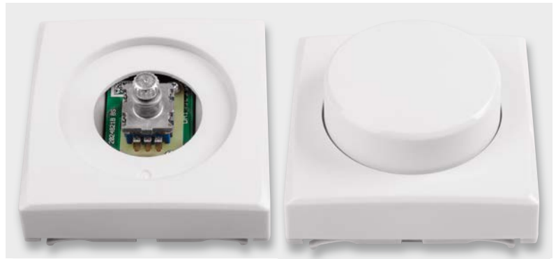
Bild 8: Zur Endmontage des Gehäuses werden die Gehäuseober- schale und der Bedienknopf aufgesetzt.
