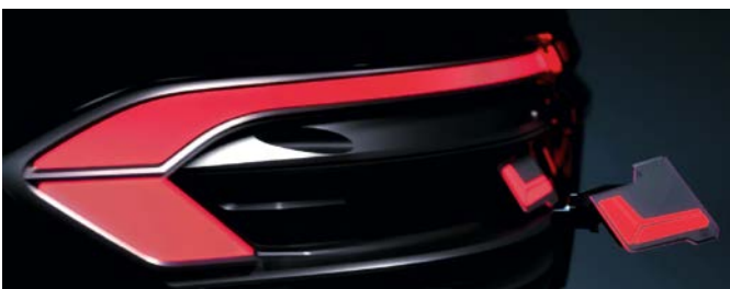
Bild 28: Ein Leuchtenbild wie aus einem Science-Fiction-Film – die OLED-Beleuchtung am aktuellen Audi A8. Links unten ist der Aufbau der einzelnen Elemente gezeigt. Bilder: HELLA
