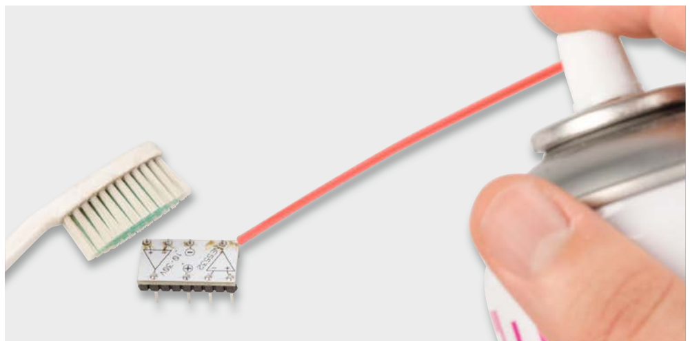
Bild 10: Mit einer Zahnbürste und einem Reiniger werden Rückstände vom Flussmittel entfernt. (hier als Beispiel eine Platine vom PAD2).
