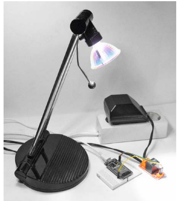
Bild 4: Schalten einer 12-V-Halogenlampe via ESP32 und Relaismodul
