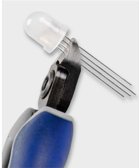
Bild 6: So sind die LED-Anschlüsse der WS2812 zu kürzen.
