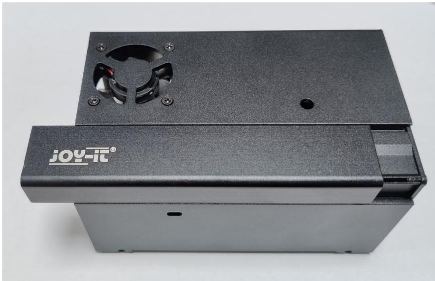
Montieren Sie die Abdeckung für die USB- und Ethernet-Ports. Achten Sie darauf, dass der Pi3 und der Pi4 unterschiedliche Blenden benötigen.
