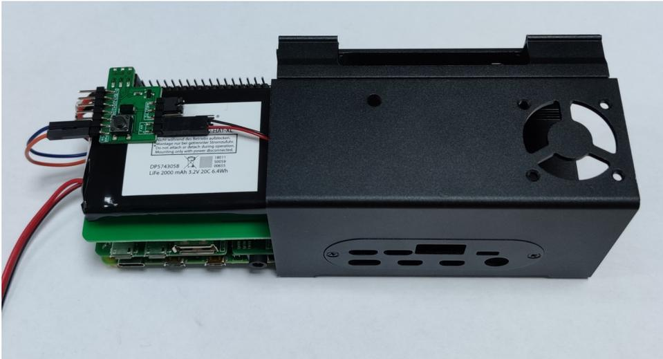
Verschrauben Sie den Lüfter mit den langen schwarzen Schrauben mit dem Gehäuse. Achten Sie dabei darauf, dass kein Kabel an die Rotorblätter des Lüfters gelangt.
