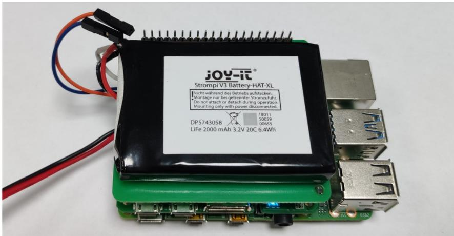
Stecken Sie als nächstes die mitgelieferte Platine auf die ersten Pins des Battery-HATs und verbinden Sie die zuvor an den StromPi angelöteten Kabel an die unteren zwei Pins der linken Seite der Platine. Dabei ist es egal welches Kabel auf welchen Pin gesteckt wird.
