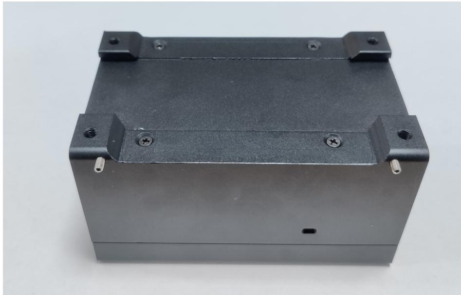
Zur Befestigung auf einer Hutschiene, haken Sie zunächst die untere Seite ein und drücken dann den oberen Teil nach. Sie können das Gehäuse noch auf der Hutschiene verschieben, um es auf der Schiene zu fixieren, drehen Sie die Madenschrauben mit dem mitgelieferten Innensechskantschlüssel fest.
