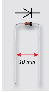
Bild 7: Die Polaritätskennzeichnung der Diode sowie die exakt abgewinkelten Anschlüsse
