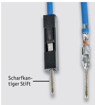
Bild 6: Flachband-Kabelset mit „Dupont“-Stecker
