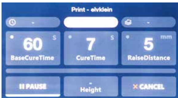
Bild 16: Über das Drucker-Display hat man die volle Kontrolle. Hier lassen sich u. a. alle wichtigsten Druckparameter nochmals nachjustieren.
