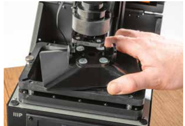
Bild 8: Beim Monoprice Mini gibt es ein selbstnivellierendes Druckplattformsystem, hier halten vier starke Magnete die Druckplattform fest.
