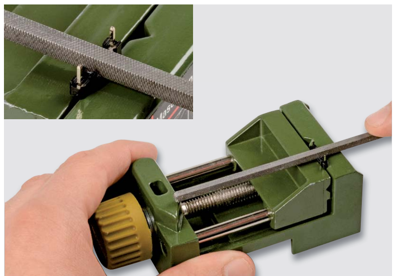
Bild 12: Mit einer Feile wird die Stiftleiste bearbeitet. Dabei ist ein kleiner Schraubstock sehr hilfreich.
