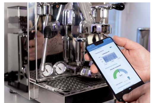
Die Espressomaschine im Smart Home Labor kann bereits per Homematic Schaltsteckdose über eine Oberfläche angesteuert werden.
