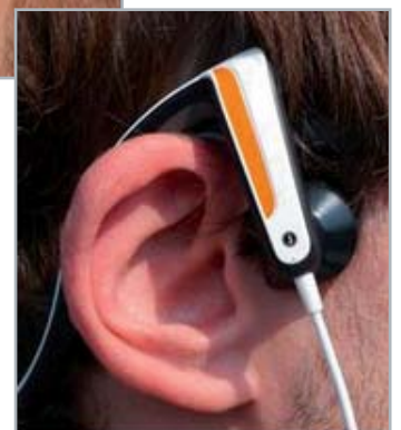
Bild 16: Knochenschallhörer mit Nackenbügel in farblich ansprechender Ausführung
