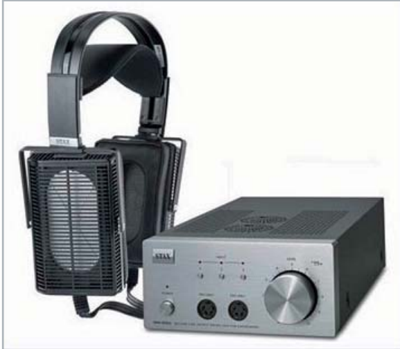
Bild 12: Elektrostatische Kopfhörer benötigen wegen des quadratischen Kraftgesetzes ( F \sim u^2 ) eine Polarisationsvorspannung. Dazu gab es anfangs zu jedem „Elektrostaten“ eine passende Hochspannungsversorgung. Das waren das „gewichtige“ Netzteile (siehe oben im Bild). Heute werden moderne Elektrostaten meist zusammen mit einem passenden Verstärker, oft röhrenbestückt, angeboten, der alles Erforderliche enthält (siehe unten im Bild).
