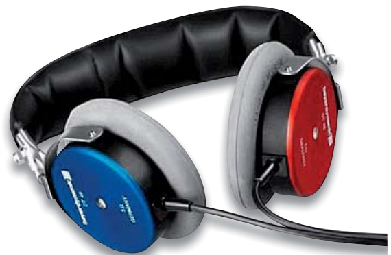
Bild 2: Kopfhörer DT48, einer der ersten elektrodynamischen Kopfhörer. Dieser Hörertyp wurde von der Firma Beyerdynamik erstmals im Jahre 1937 auf den Markt gebracht, ursprünglich nur für den Einsatz bei Funk- und Telefontechnikern. Später wurde daraus der meistverwendete Kopfhörer in der Audiometrie.
