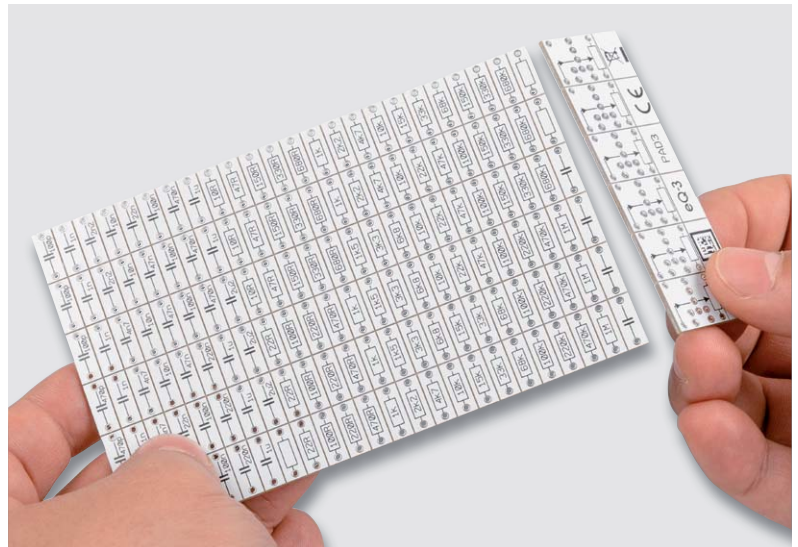
Bild 8: So werden die Platinenabschnitte vom Nutzen getrennt.
