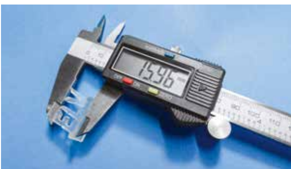
Bild 18: Die Maßhaltigkeit ist für solch ein einfaches Gerät wie den Monoprice Mini sehr gut – angelegt ist das Logo mit 16 mm Höhe.
