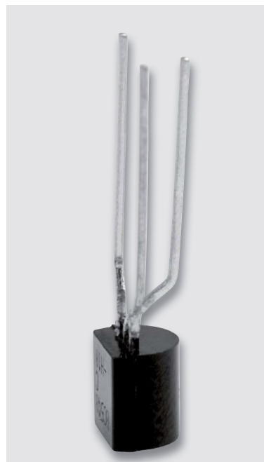
Bild 10: Der mittlere Anschluss des Transistors ist wie hier gezeigt in Richtung runde Gehäuseseite abzuwinkeln.
