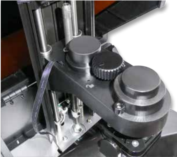
Bild 15: Hier sieht man den Stellmotor für die automatische Kalibrierung. Er sorgt für eine automatische Ausrichtung der im Ruhezustand lose eingespannten Druckplattform und den exakten Abstand bei der Kalibrierung über der FEP-Folie.
