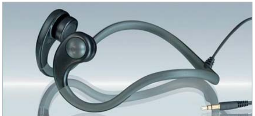
Bild 15: Knochenhörer mit Nackenbügel. Damit kann man via Knochenleitung z. B. Musik hören, ohne dabei die Gehörgänge zu verschließen und sich z. B. beim Überqueren einer verkehrsreichen Straße in Gefahr zu bringen.
