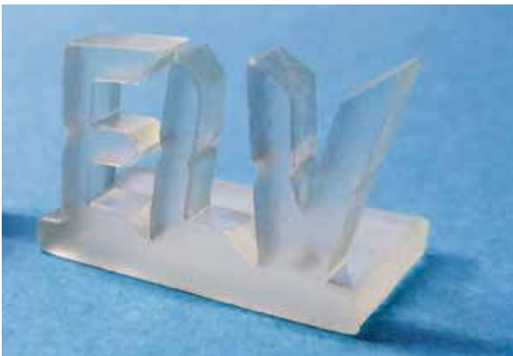
Bild 17: Der kleine Beispieldruck des ELV Logos zeigt auch in der Vergrößerung eine nahtlose, transparente Struktur.
