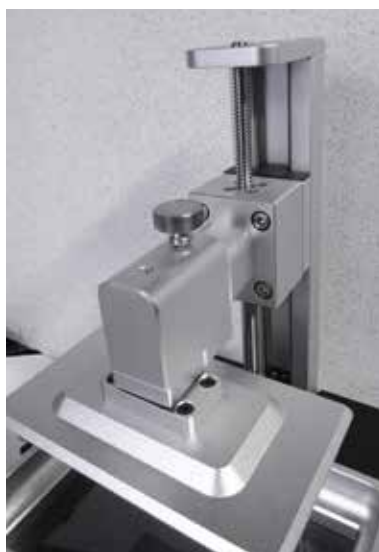
Bild 7: Das weit verbreitete Konstruktionsprinzip der Aufhängung der Druckplattform, hier am Anet A4: Plattform samt Träger mit einer Rändelschraube auf der Z-Achse fixiert. Die Ausrichtung der Plattform erfolgt halbautomatisch, deren Fixierung über vier Schrauben.
