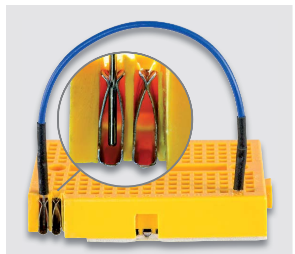
Bild 4: Die Buchsenkontakte eines Steckboards im Detail
