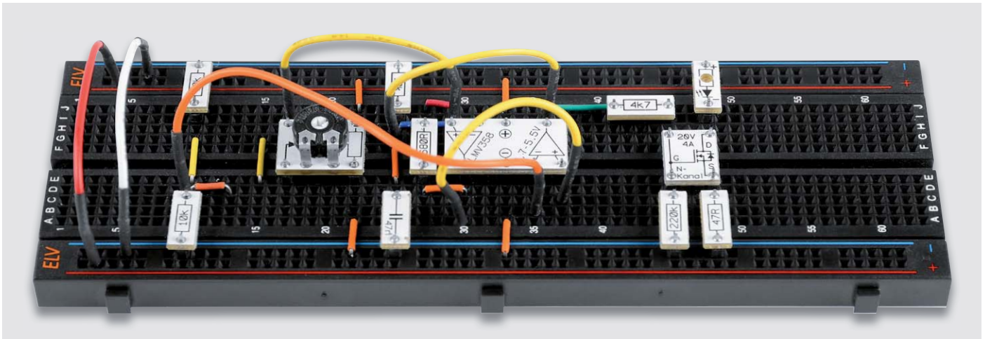
Bild 1: Beispielschaltung unter Verwendung von Steckkabeln und Steckbrücken und unseren neuen Prototypenadaptern PAD2 und PAD3
