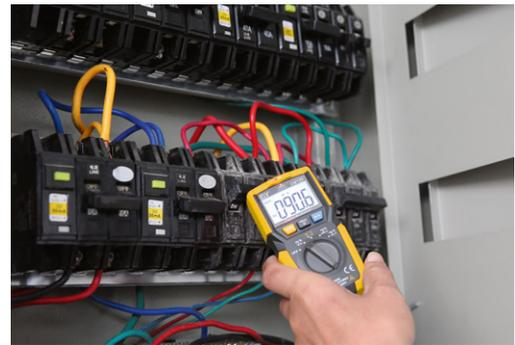
Das robuste Pocket-Multimeter ELV DM100 ist ein universell einsetzbares und einfach zu bedienendes Vielfachmessgerät, das in CAT-III-Umgebungen bis 600 V einsetzbar ist. Neben den Standardmessarten bietet es die Möglichkeit, berührungslos Wechselspannungen, z. B. zur Leitungssuche, zu detektieren.
